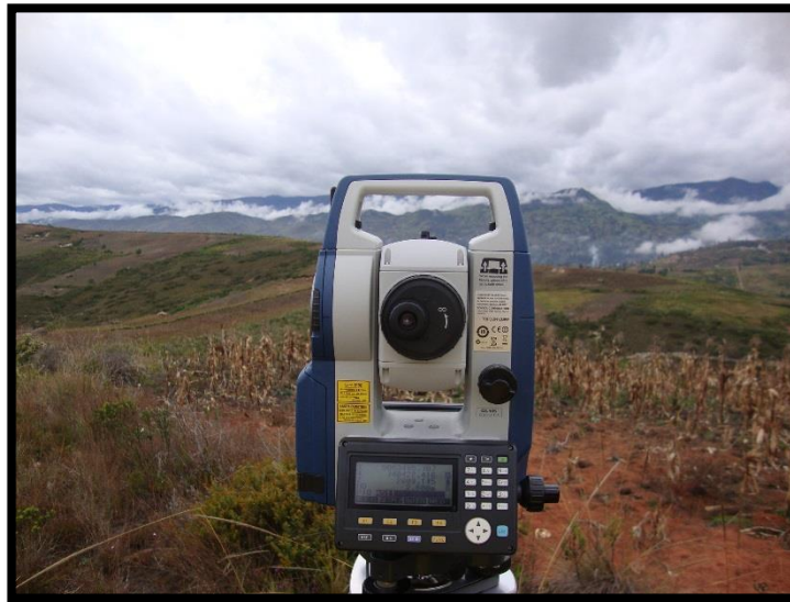
Equipo para levantamiento topográfico Estación total SOKIA CX 105 precisión 5 segundos
