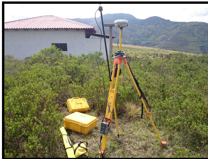
Equipo para levantamiento topográfico GPS diferencial TRIMBLE
