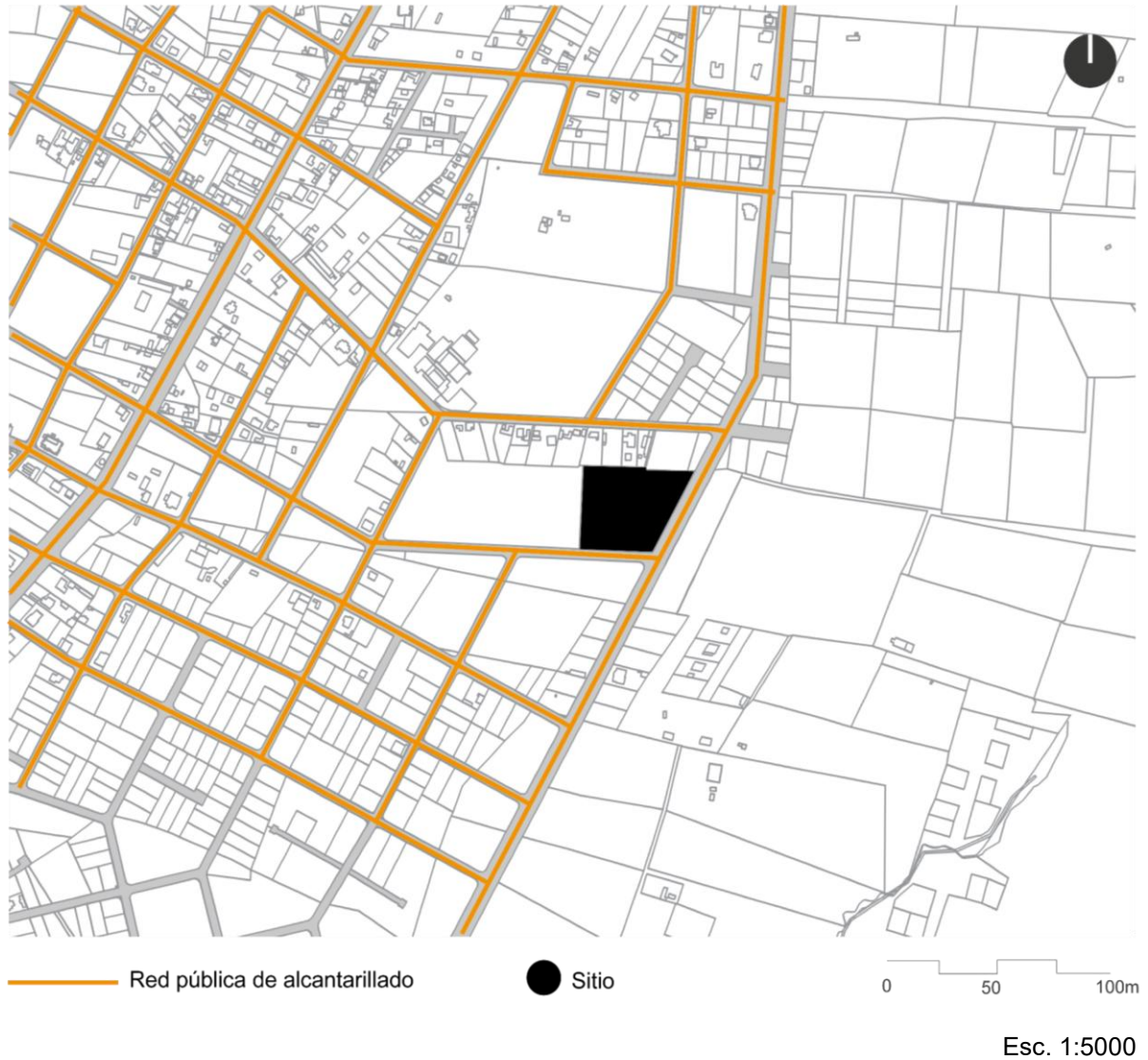
Figura 81. Red Pública de Alcantarillado.
