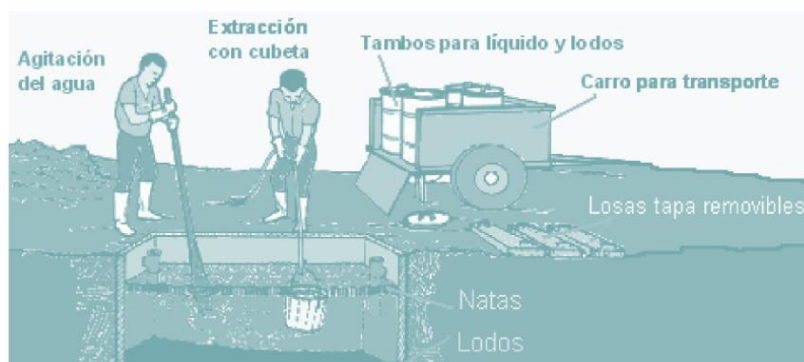
Figura 25: Limpieza de lodos de una fosa séptica.
