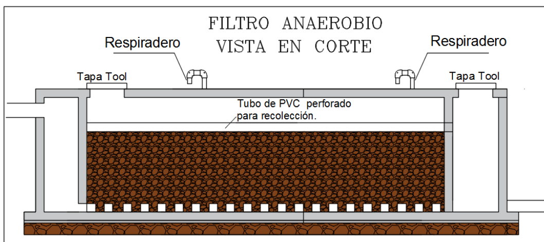
Figura 20: Esquema de un filtro anaerobio. Fuente: Autor.
