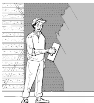
Figura 10: Aplicación de la segunda capa: para afinar la superficie y dar un acabado estético tras el secado de la primera capa.
