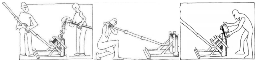
Figura 19: Proceso de compactación.
