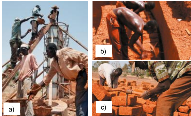
Figura 26 Proceso de elaboración del BTC; a) Preparación de la mezcla; b) Compactación en molde; c) Curado y secado
