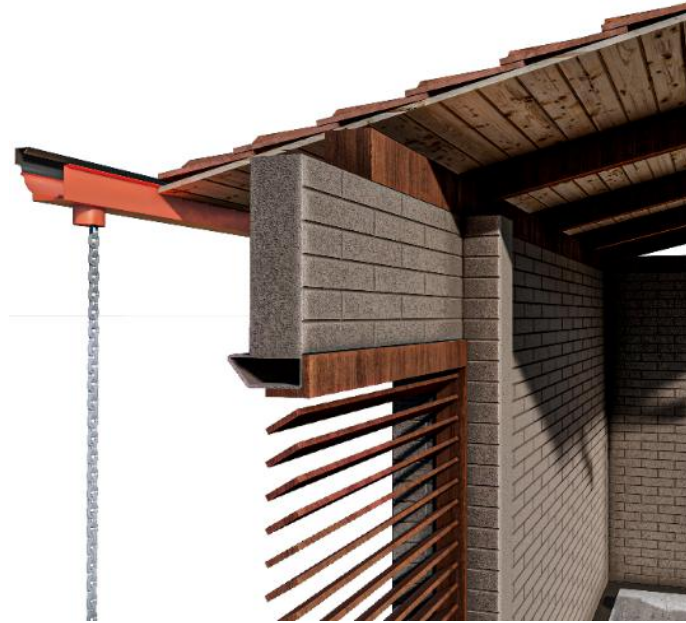
Figura 60: Estructura de cubierta de madera
