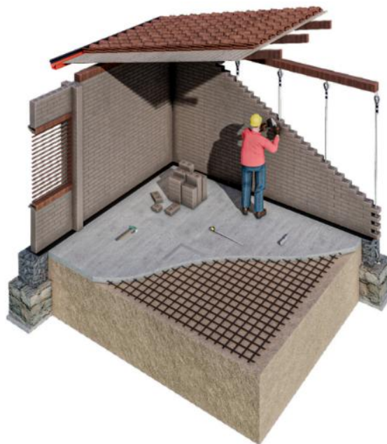
Figura 54: Proceso constructivo de la mampostería con refuerzo y elementos estructurales
