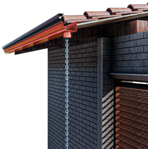
Figura 62: Canalón tipo tolva y cadena de lluvia
