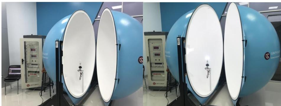
Figura 95. Luminaria sometida a prueba en la Esfera de Ulbricht
