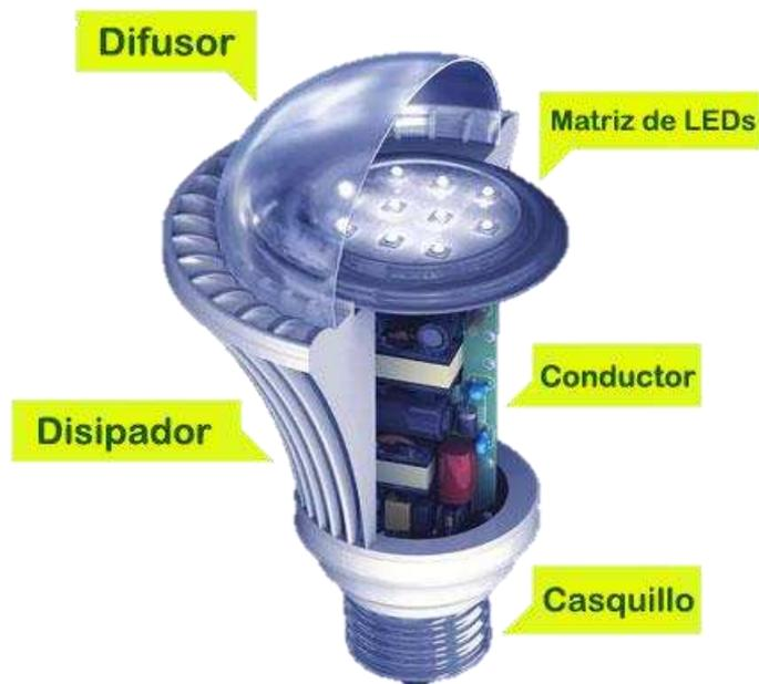
Figura 43. Partes de una luminaria LED
