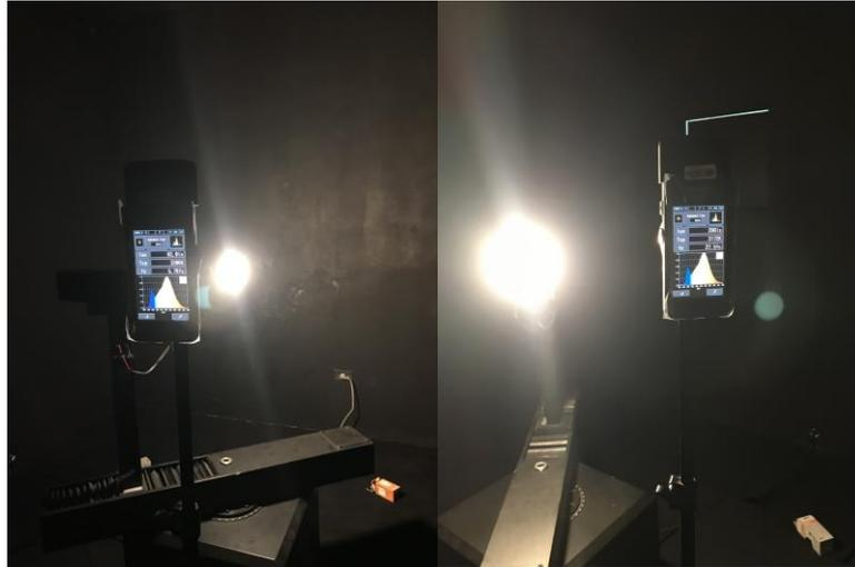
Figura 99. Medición de luxes con el equipo Sekonic C -700 en el cuarto oscuro
