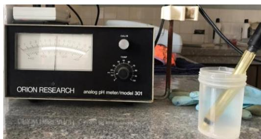
*Imagen 11. pH metro/modelo 301 para análisis de potencial de hidrogeno en muestras de agua. – Fuente:(Autor, 2021)*
