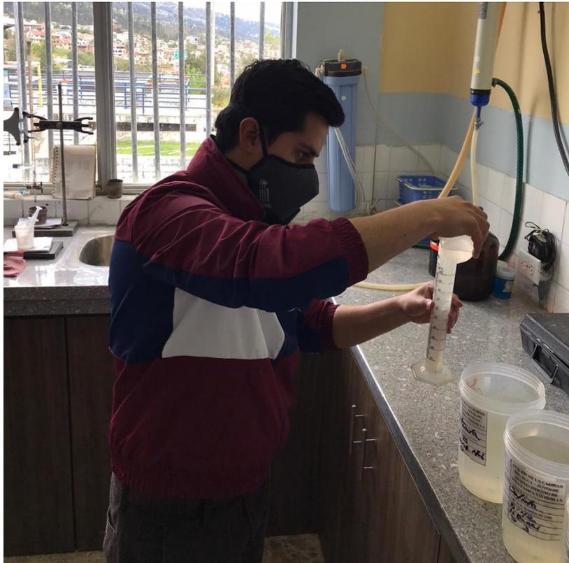
*Imagen 32. Preparación de muestras de agua en laboratorio para evaluación de su calidad. – Fuente:(Autor, 2021)*
