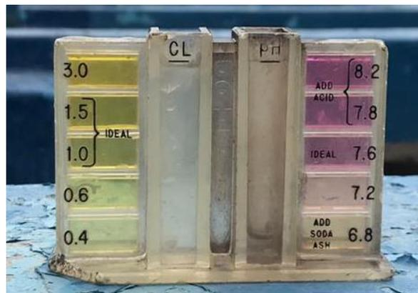
Imagen 5. Comparador de cloro para análisis de cloro residual. – Fuente:(Autor, 2021)
