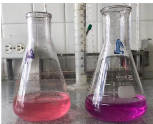
*Imagen 10. Cambio de coloración en la determinación de dureza cálcica en muestras de agua. – Fuente:(Autor, 2021)*
