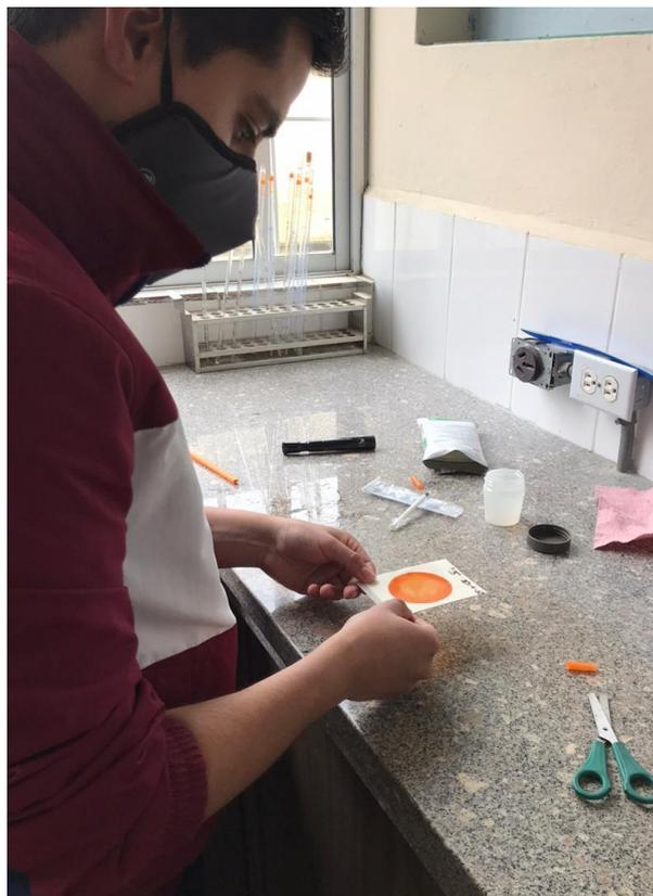
*Imagen 33. Preparación de placas Petrifilm para la caracterización microbiológica de muestras de agua perteneciente a la Junta Pampa Vintimilla. – Fuente:(Autor, 2021)*
