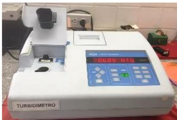
*Imagen 12. Turbidímetro HACH 2100AN para análisis de turbiedad. – Fuente:(Autor, 2021)*
