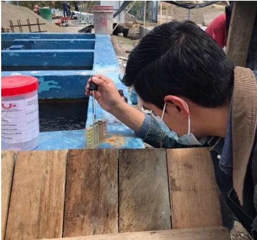
*Imagen 30. Proceso de caracterización de cloro residual efectuados en la Junta Pampa Vintimilla mediante un recipiente comparador de cloro y reactivo del tipo ortotolidina. – Fuente:(Autor, 2021)*
