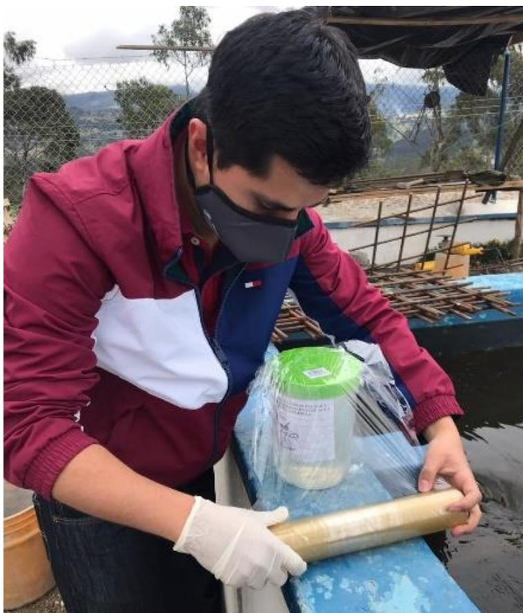
*Imagen 29. Proceso de empaquetado para tomas de muestras destinadas a la evaluación de la calidad del agua. – Fuente:(Autor, 2021)*
