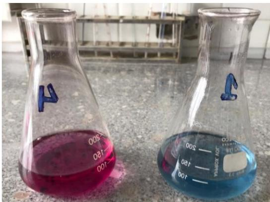
*Imagen 9. Cambio de coloración en la determinación de dureza total en muestras de agua. – Fuente:(Autor, 2021)*
