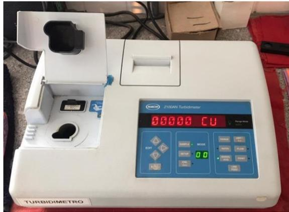
Imagen 6. Colorímetro HACH 2100AN para análisis de color en muestras de agua. – Fuente:(Autor, 2021)
