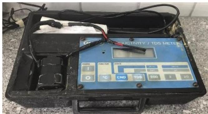
Imagen 7. Conductímetro HACH para la medición de la conductividad. – Fuente:(Autor, 2021)
