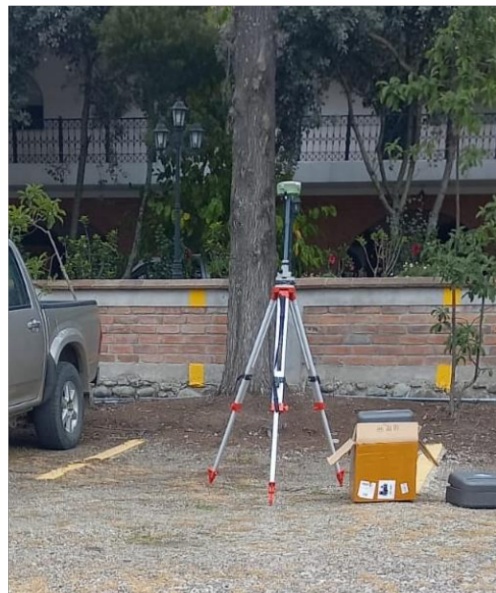
Figura 45. Receptor geodésico establecido como base
