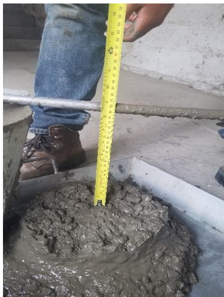
Ilustración 4.9 Ensayo de asentamiento.
