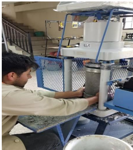
Ilustración 4.10 Ensayo resistencia a la compresión.
