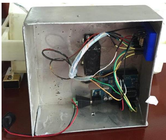
Fig. 26 Circuito electrónico del seguidor solar.
