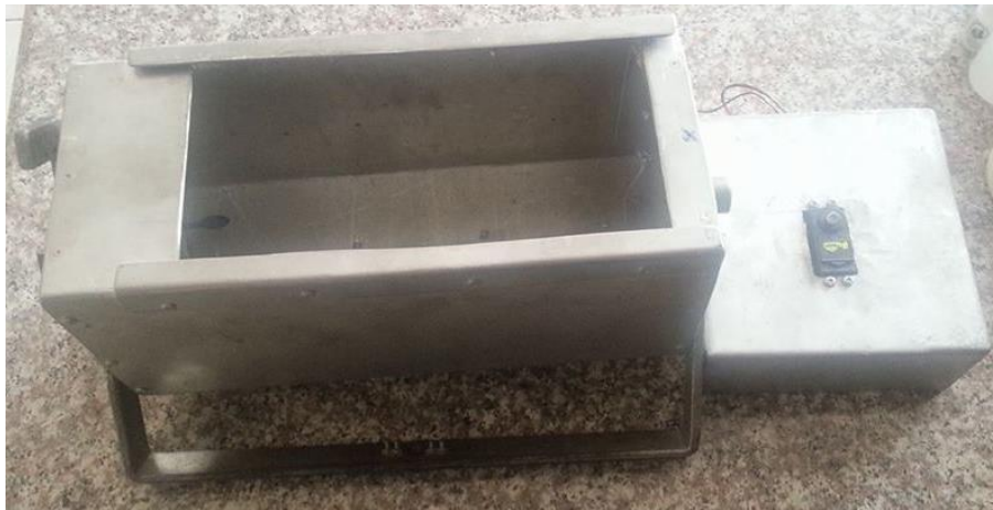
Fig. 23 Prototipo del concentrador solar construido en aluminio.
