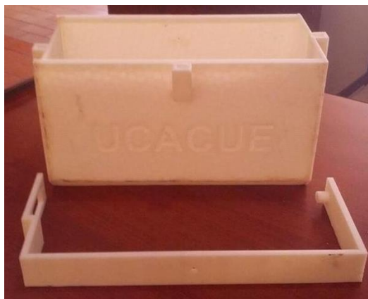
Fig. 25 Prototipo del concentrador solar construido con plástico ABS.
