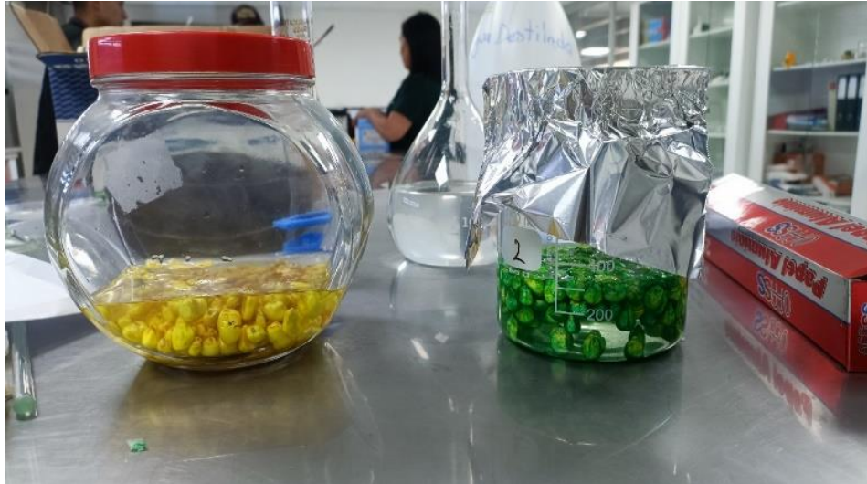
Figura 9 Maceración con hidróxido de sodio al 0.1 %
