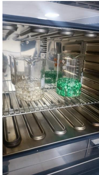
Figura 8 Maceración en estufa, sin tratamiento de hidróxido de sodio
