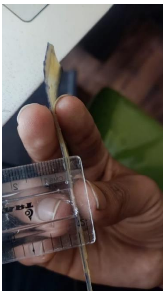
Figura 27 Medición de grosor del bioplástico
