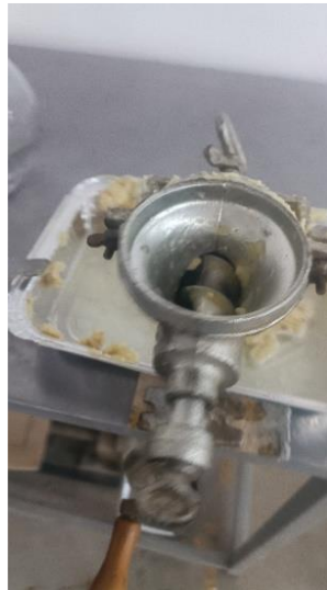
Figura 10 Molienda húmeda mediante uso de molino manual
