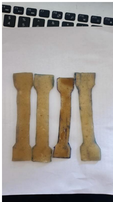
Figura 31 Probetas para pruebas de fuerza y elongación
