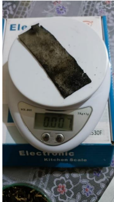
Figura 32 Pesaje de muestras diariamente, para degradabilidad aerobia
