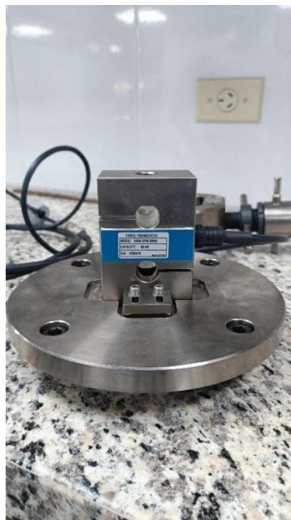
Figura 28 Transductor de fuerza, capacidad 20 kN
