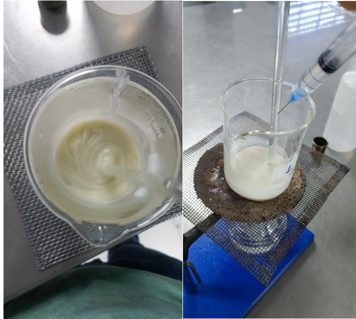
Figura 21 Mezcla de almidón, agua destilada y aditivos plastificantes como glicerina y ácido acético
