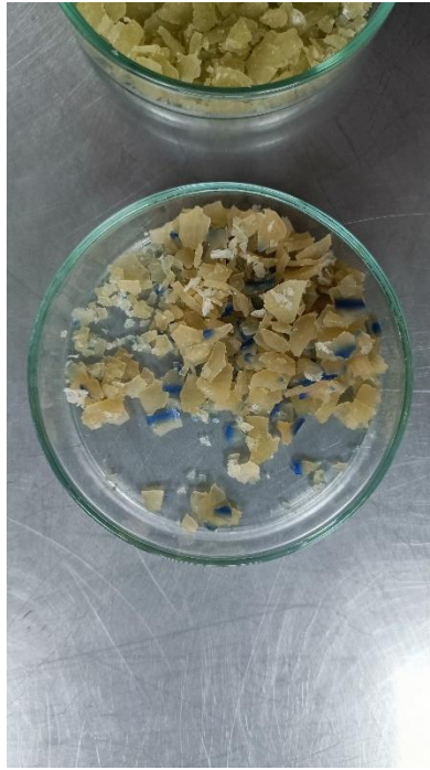
Figura 22 Bioplástico obtenido muy quebradizo
