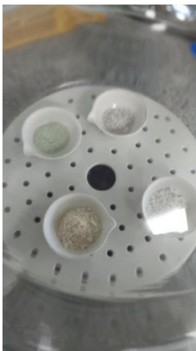
Figura 20 Muestras colocadas en el desecador, para determinar la humedad
