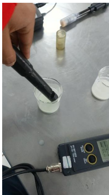
Figura 19 Determinación de pH del almidón obtenido
