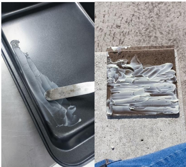
Figura 24 Aplicación del método casting en placa de vidrio
