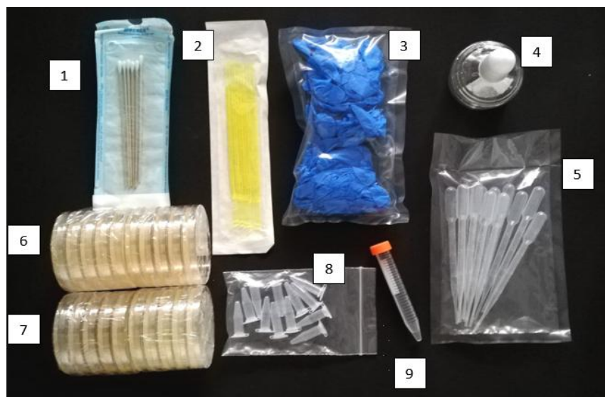
Fig 11. (1) Hisopos estériles, (2) Asas estériles, (3) Guantes de nitrilo talla M, (4) Mechero, (5) Pipetas Pasteur de plástico de 5 ml, (6) 10 Cajas de Petri con medio
