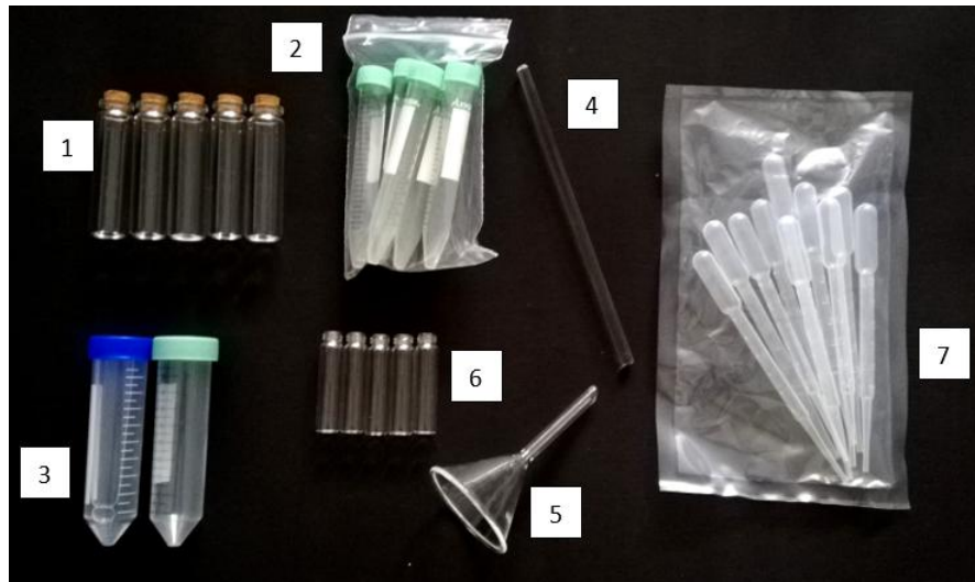
Fig 2. Materiales del kit DNA Discover. (1) 5 Tubos con tapa de corcho (Filtración), (2) 5 Tubos cónicos de 15 ml (maceración), (3) Solución de lisis en Tubo tapa rosca 50 ml, (4) Varilla de vidrio, (5) Embudo, (6) 5 Tubos de 5 mL, (7) 5 Pipetas Pasteur de plástico de 5 mL.
