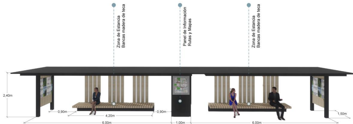
Figura 118: Mobiliario urbano, parada de transporte público.
