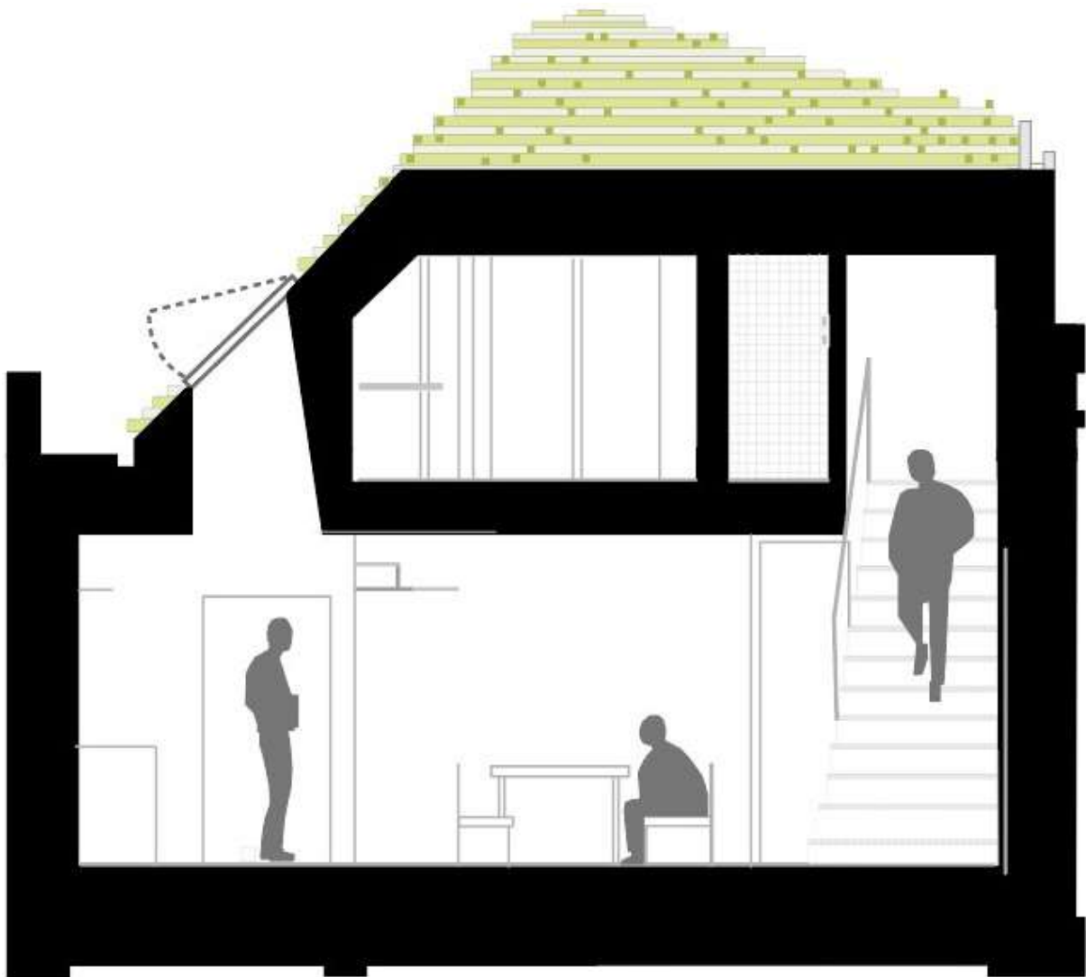
FIGURA 3.9: Sección tragaluz del dormitorio y jardín de invierno
