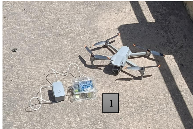
Ilustración 10 Equipo de vibración ambiental instalado en el tablero en la parte central
