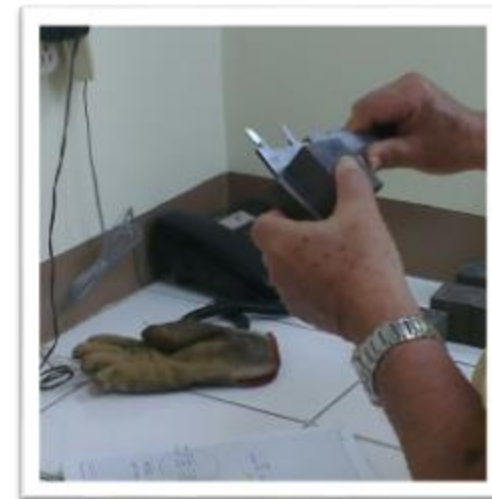
Fotografía 3.5 Ensayo. Resistencia a la Compresión, mediciones a cada uno de los elementos a ser ensayados
