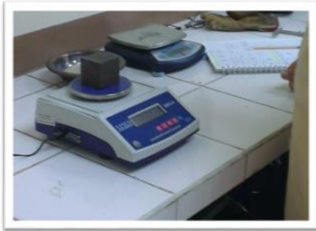
Fotografía 3.6 Ensayo. Resistencia a la Compresión, pesaje a cada uno de los elementos a ser ensayados
