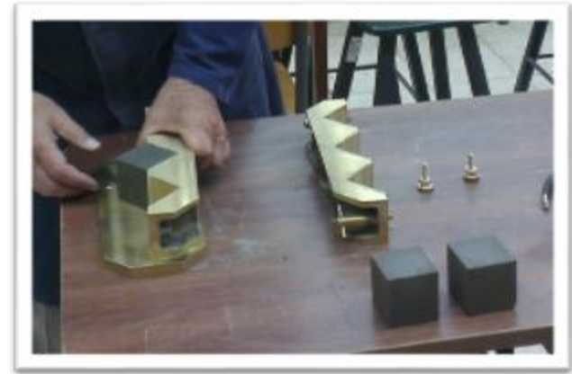
Fotografía 3.3 Proceso de desencofrado para su posterior curado
