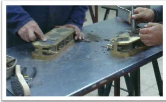
Fotografía 3.1 Preparación de los moldes para especímenes
