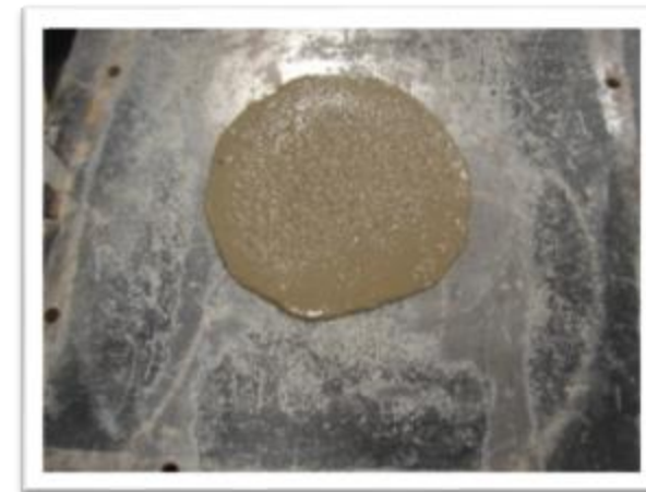
Fotografía 2.3. Producto final. Pasta de cemento
