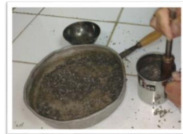
Fotografía 2.8 Dosificación volumétrica de los morteros adicionando PET
