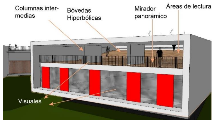
Figura 68: Cubierta área de cohesión social
