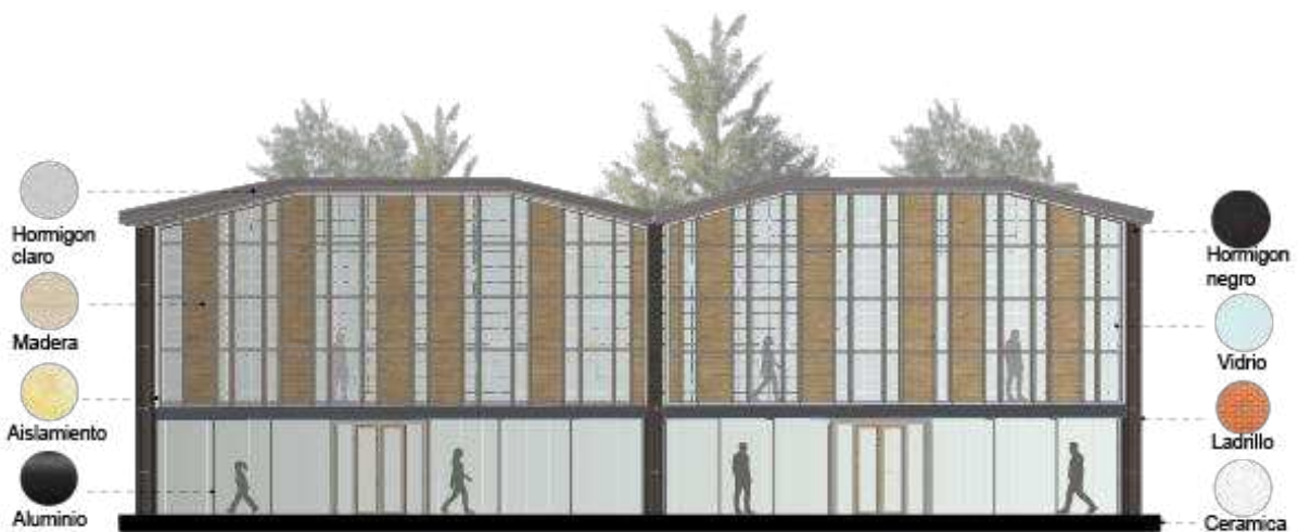
Figura 4.22: Materialidad empleada en el edificio
