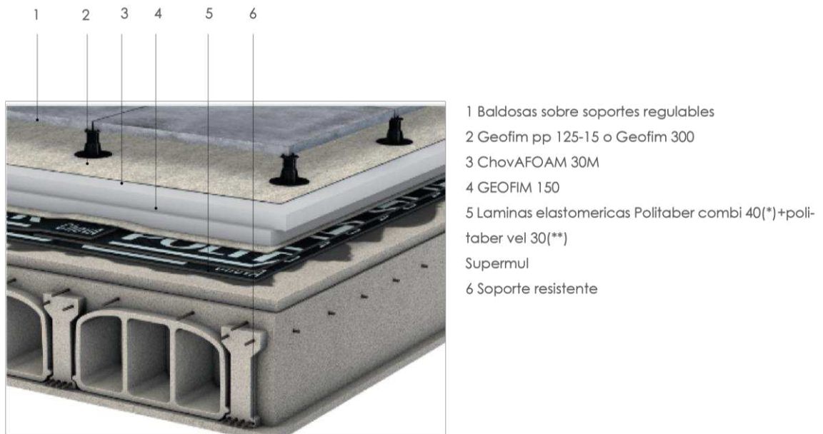
Figura 2.79: Detalle constructivo de losa
