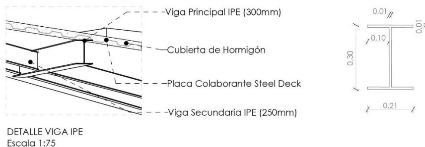
Figura 115: Detalle constructivo de la viga “IPE”.
