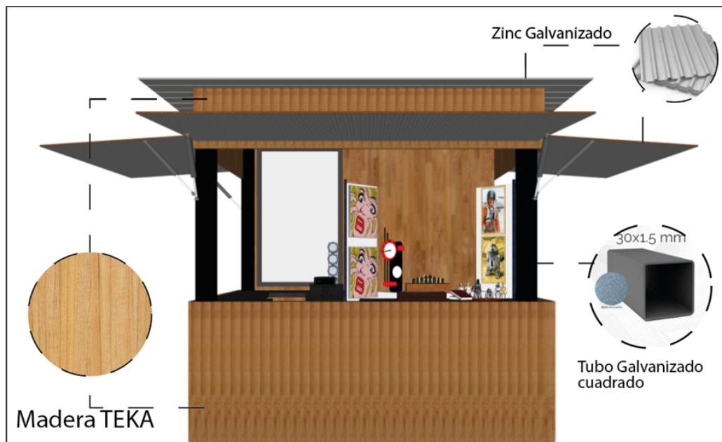
FIGURA 4.50: Mobiliario para Locales Artesanales. El detalle constructivo se encuentra en el Anexo 15. Elaboración: Propia.
