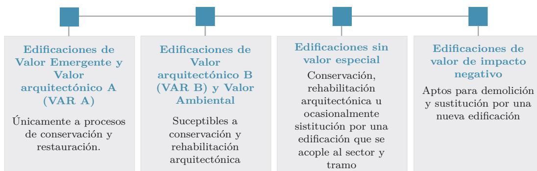
FIGURA 1.20: Tipos de intervención en edificaciones según su valoración. Fuente: Heras y Orellana (2016). Elaboración: Autora.
