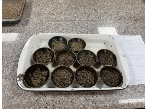
Muestras finales de ensayos de compactación
