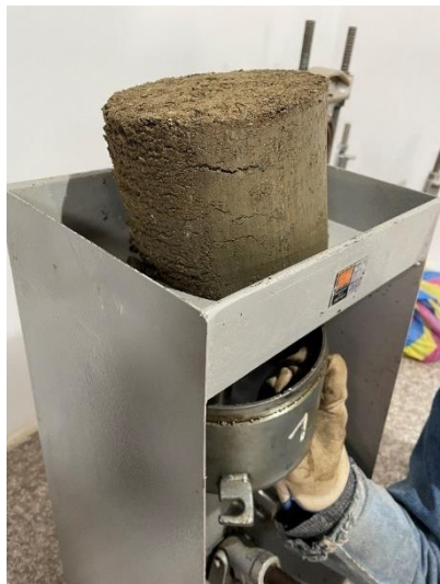
Retiro de material compactado
