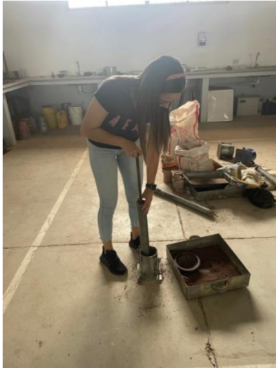
Ensayo de Proctor Estándar
