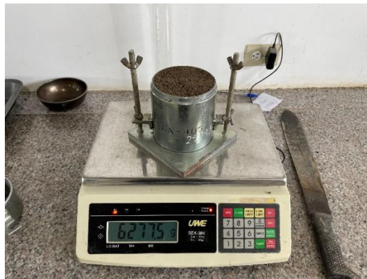
Pesado del material compactado
