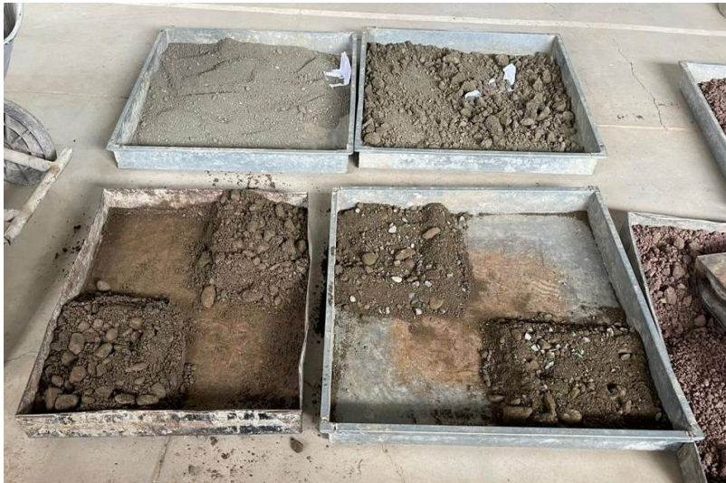
Material de Mejoramiento y Subbase
