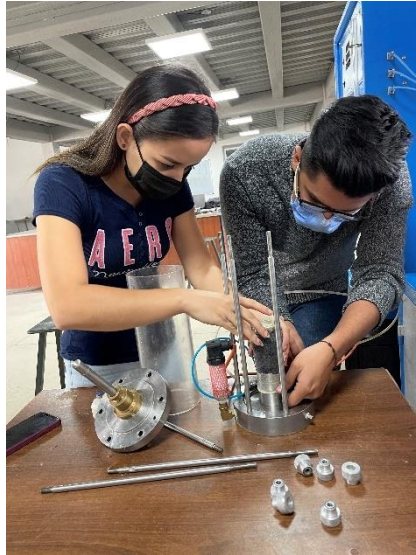
Armado de equipo Triaxial
