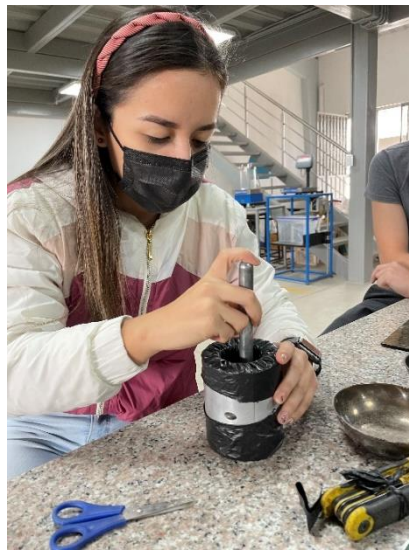
Preparación de material para ensayo triaxial
