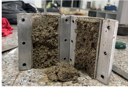
Falla inicial del material en el cilindro del ensayo Triaxial
