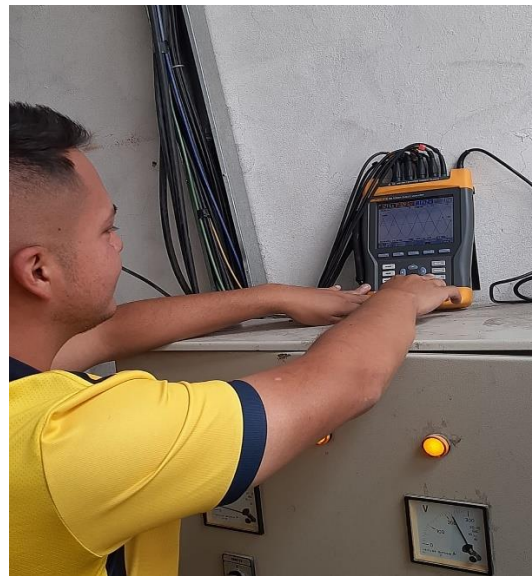
Figura 63 Instalación del equipo de calidad (FLUKE 434 Power Quality Analyzer) para medir la fiabilidad de la generación distribuida de la Unidad académica UCACUE. Fuente. Autores.
