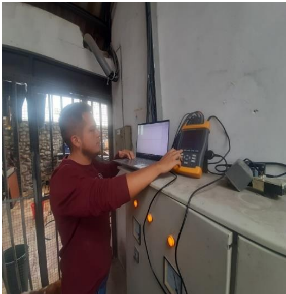
Figura 63 Instalación del equipo de calidad (FLUKE 434 Power Quality Analyzer) para medir la fiabilidad de la generación distribuida de la Unidad académica UCACUE. Fuente. Autores.
