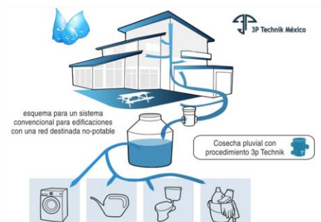
Gráfico N° 21: Esquema de captación de agua lluvia
