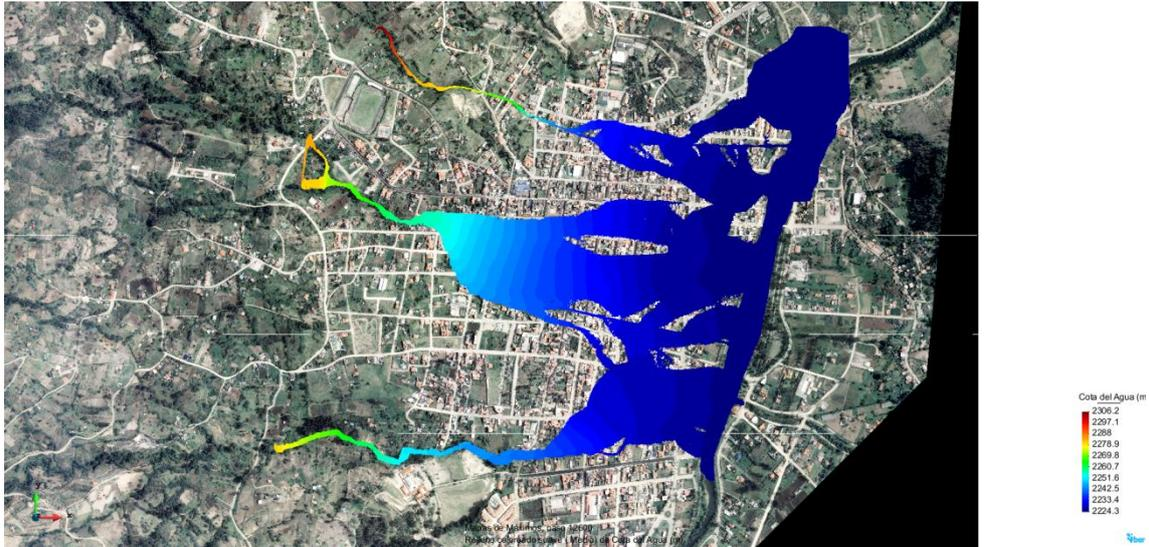
Figura 37. Post-Proceso (Áreas Coloradas Suaves). Resultados de Cota de Agua Máxima Iber 2.2
