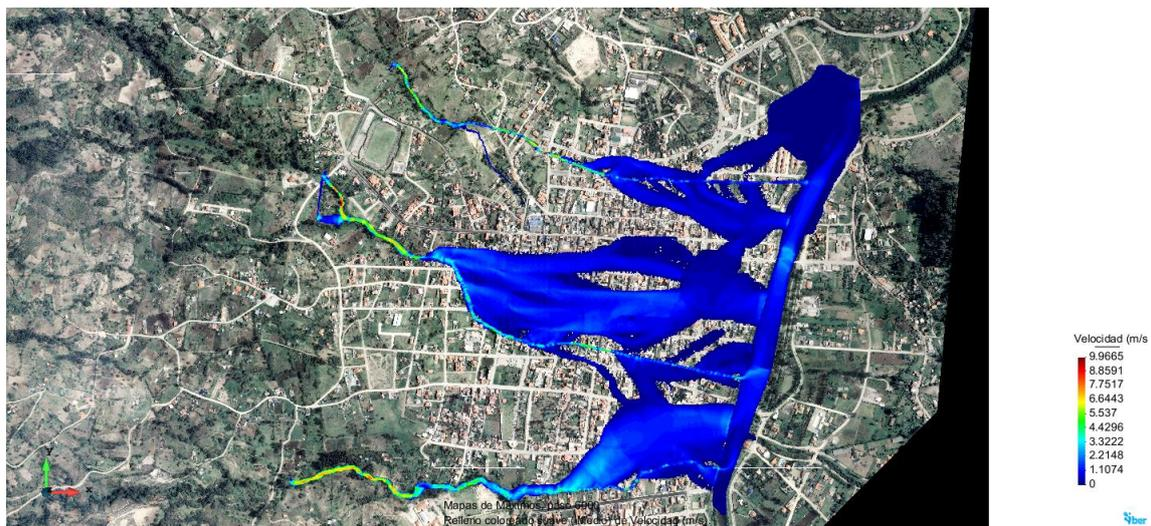
Figura 48 Resultados de Velocidad. De Modelación Hidráulica de Las Quebradas Huayrapata, Ishcay y Picay. Para un periodo de retorno de 10 años. Iber 2.2
