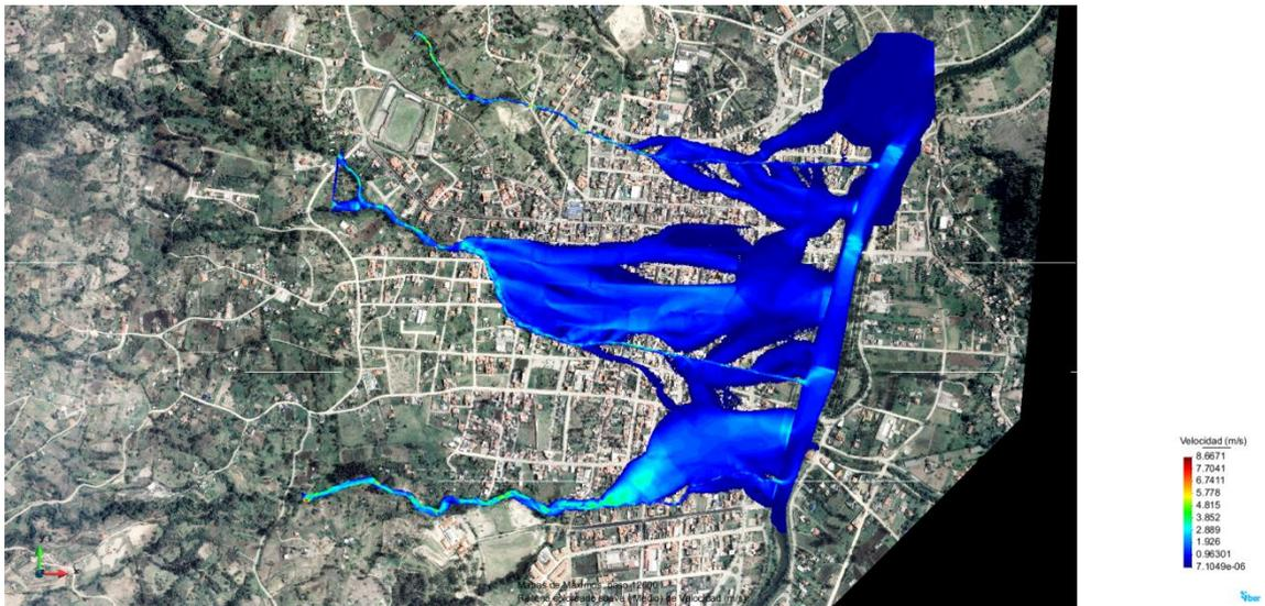
Figura 36. Post-Proceso (Áreas Coloreadas Suaves). Resultados de Velocidad Maxima (m/s) Iber 2.2
