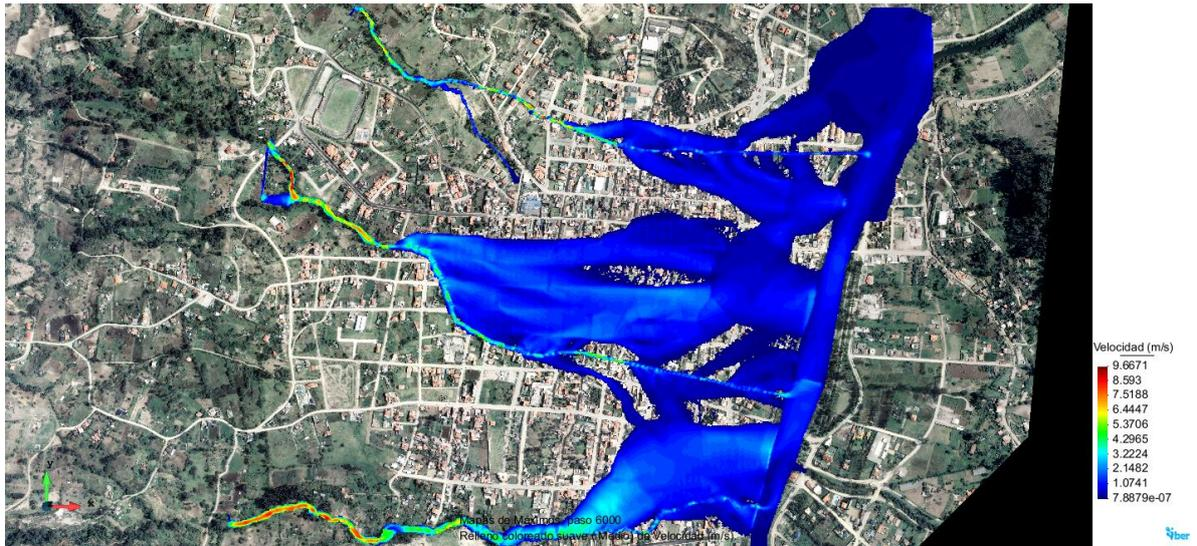
Figura 49 Resultados de Velocidad. De Modelación Hidráulica de Las Quebradas Huayrapata, Ishcay y Picay. Para un periodo de retorno de 25 años. Iber 2.2
