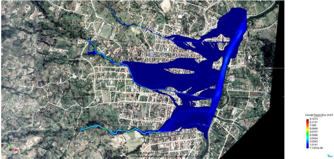
Figura 35. Post-Proceso (Áreas Coloreadas Suaves). Resultados de Caudal Especifico (m2/s) Iber 2.2
