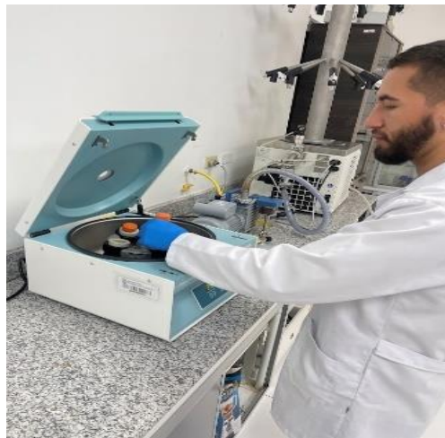
Figura A8 Centrifugación de la muestra diluida
