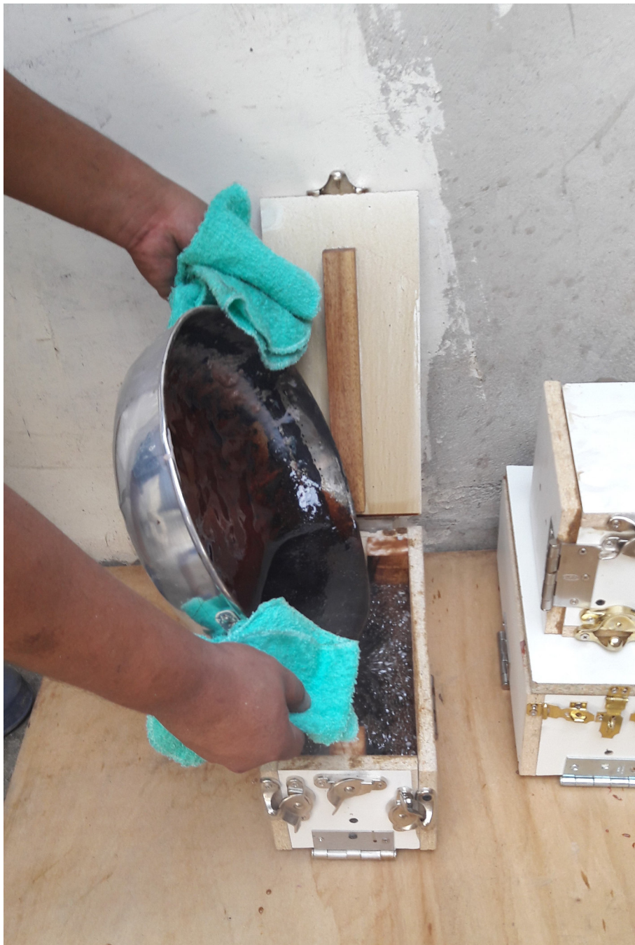
FIGURA 2.15: Vertido del PET, en el molde del Ladrillo 1, Fuente: Autor
