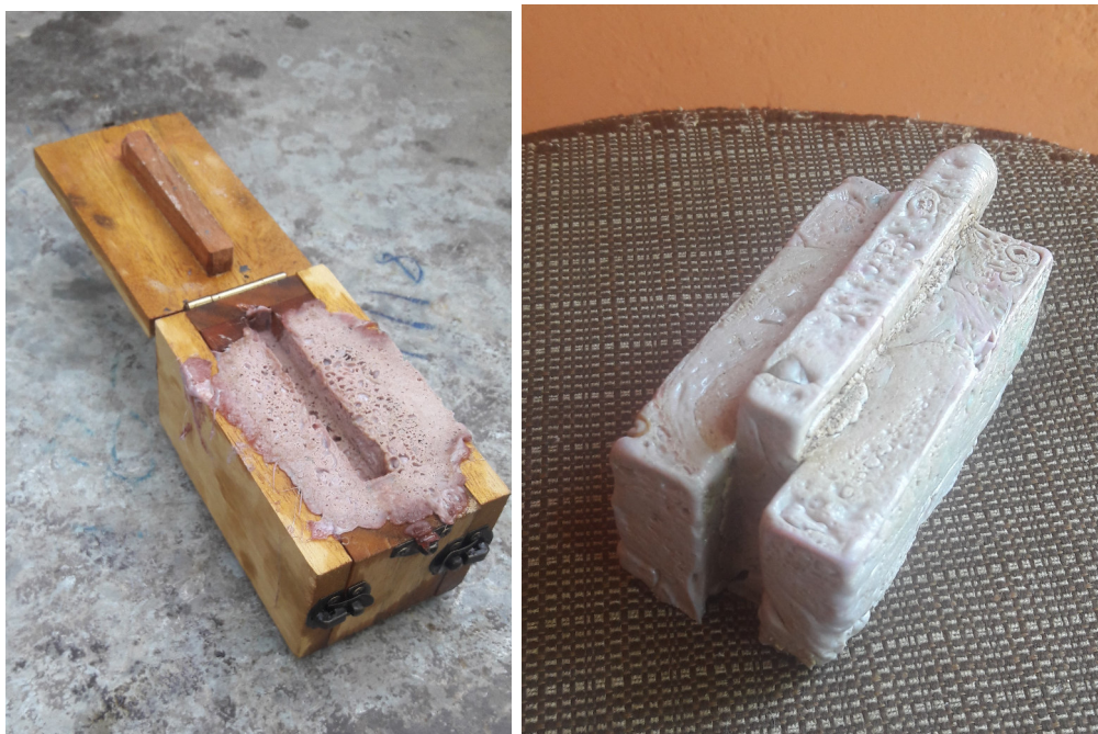
FIGURA 2.20: Desmoldado Ladrillo 2, Fuente: Autor
