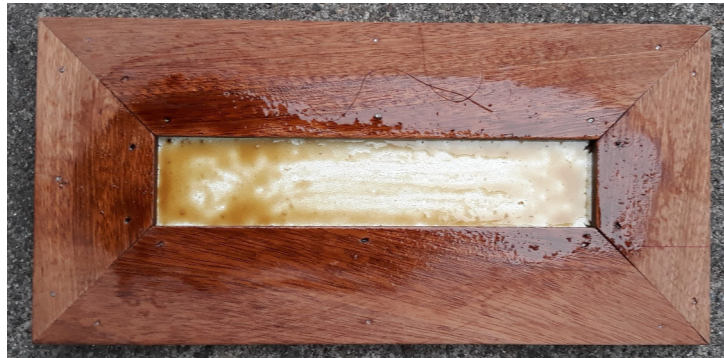
FIGURA 3.1: Molde para ensayo a la flexión-Fuente: Autor
