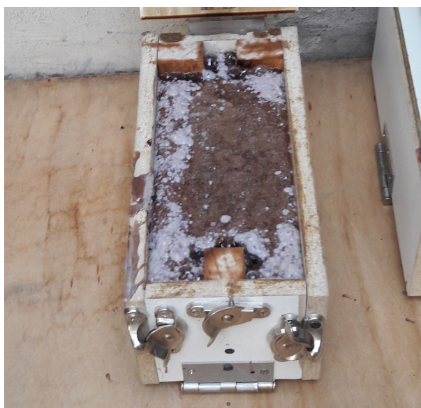
FIGURA 2.17: PET secándose antes de ser tapado el molde, Fuente: Autor
