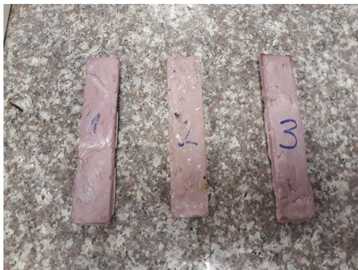
FIGURA 3.2: Probetas para ensayo a la flexión-Fuente: Autor
