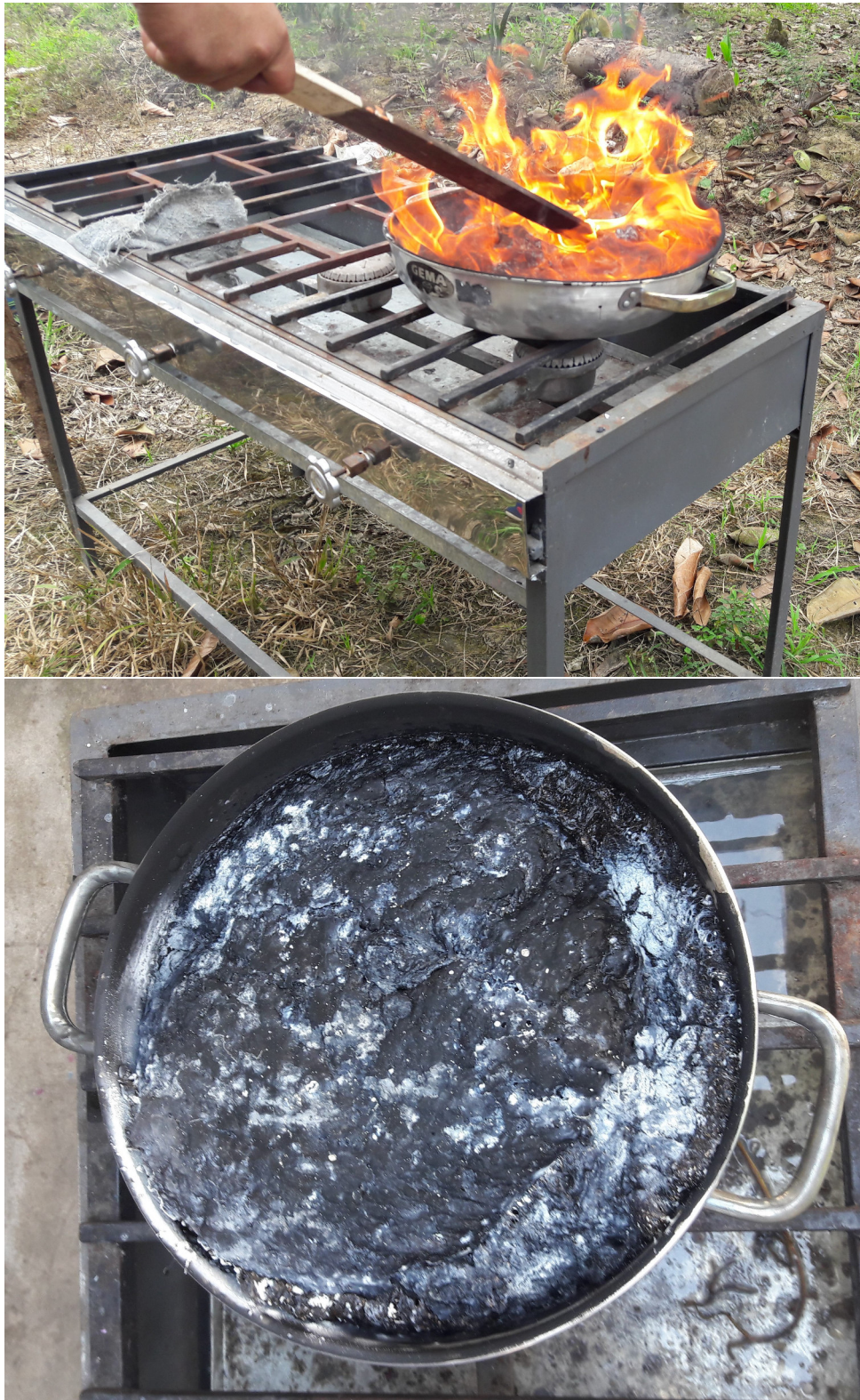
FIGURA 4.3: PET deteriorado a mayor tiempo de derretimiento, Fuente: Autor
