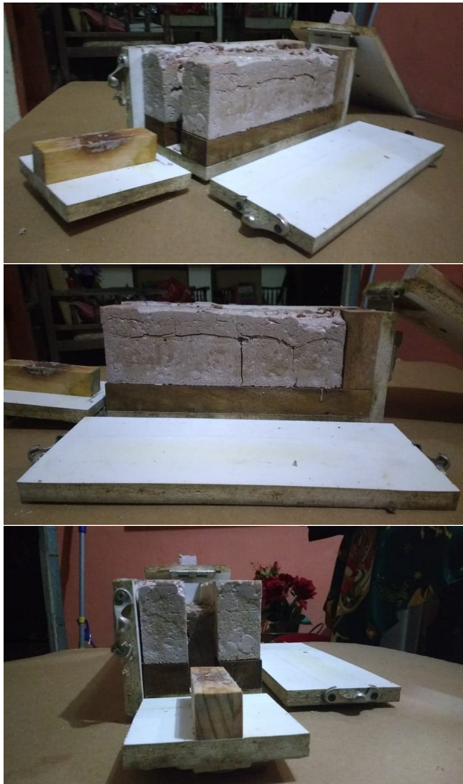
FIGURA 2.16: Desmolde, Fuente: Autor
