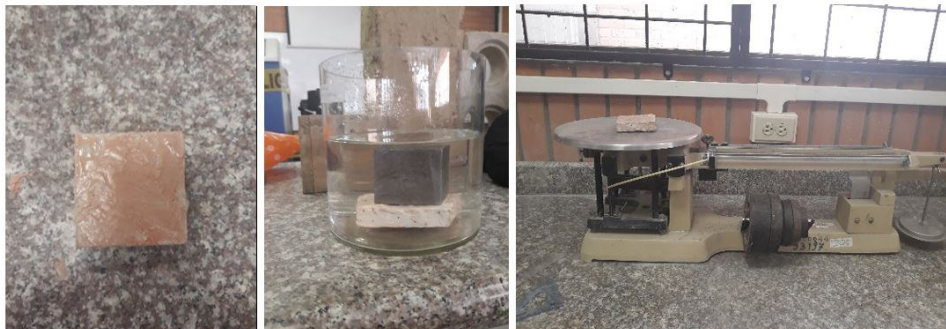
FIGURA 3.9: Ensayo de absorción de agua según ISO 62 - Fuente: Autor
