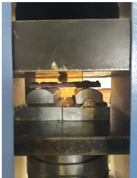
FIGURA 3.4: Esquema ensayo a la Flexión - Fuente: Autor
