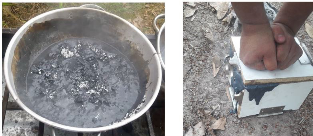
FIGURA 2.18: PET deteriorado a mayor tiempo de derretimiento, Fuente: Autor
