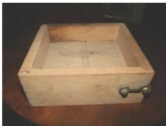
FIGURA 3.8: Molde para ensayo a la absorción- Fuente: Autor
