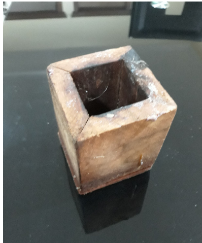
FIGURA 3.5: Molde para ensayo a la compresión-Fuente: Autor
