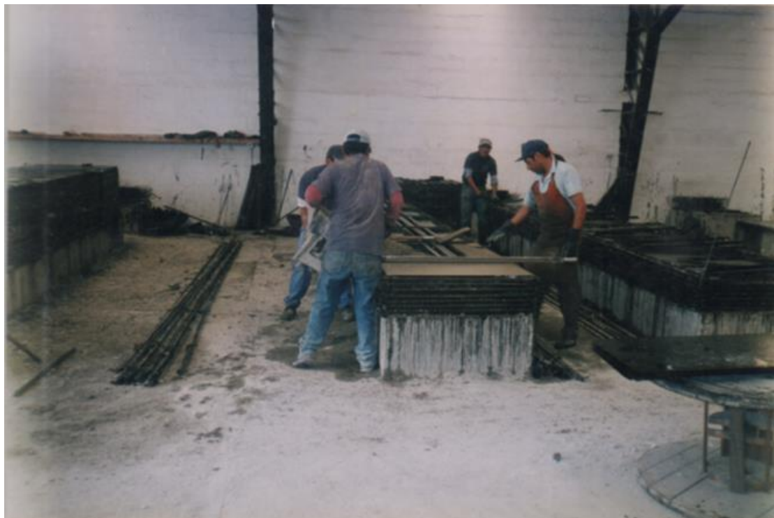
Fotografía 6.- Vaciado de la pasta de hormigón en los moldes de acero.
