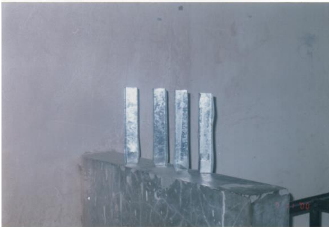
Fotografía 7 y 8.- Tipos de falla en perfiles de galvalumen a compresión.
