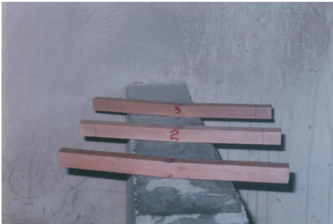
Fotografía 6.- Tipos de falla en probetas de madera a flexión.
