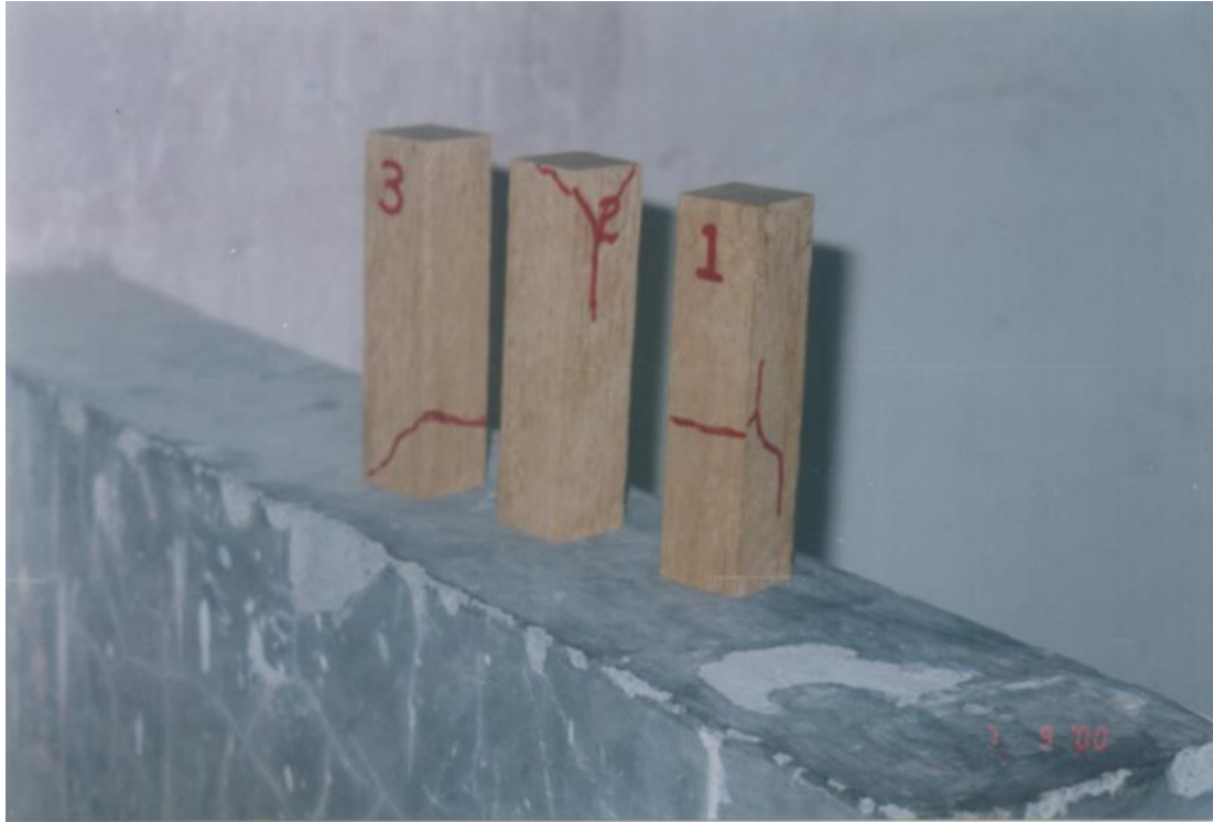
Fotografía 5.- Tipos de falla en probetas de madera a compresión.
