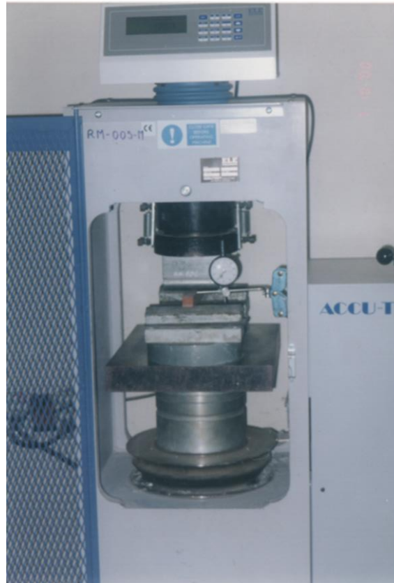
Fotografía 9.- Ensayo de compresión simple a panel de hormigón.
