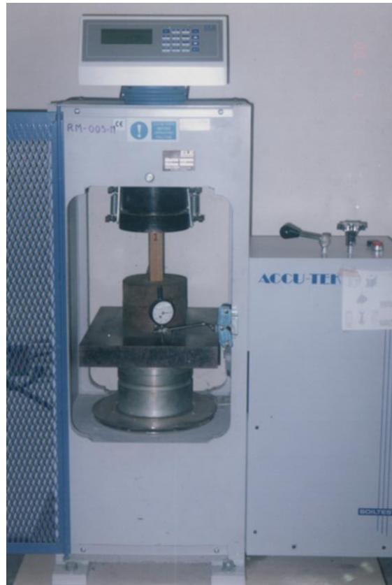
Fotografía 9.- Ensayo de compresión simple en probeta de madera.
