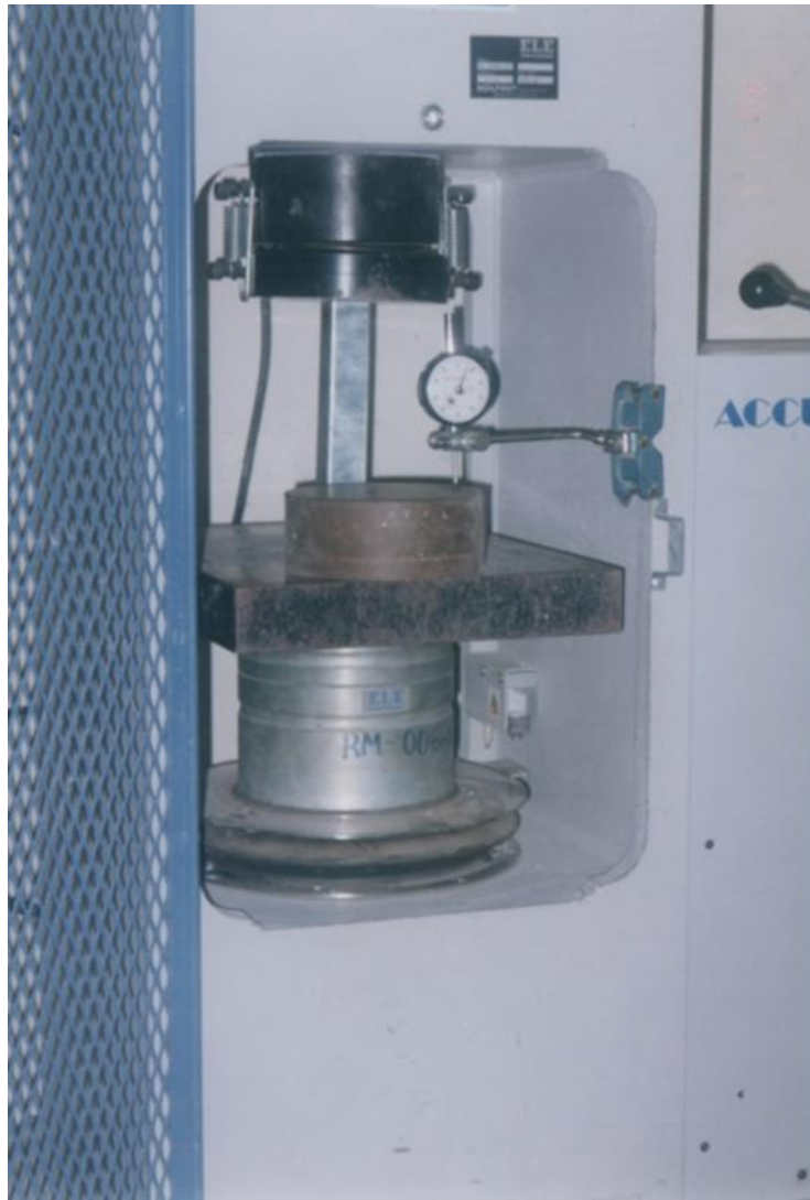
Fotografía 11.- Ensayo de compresión simple en perfil metálico.
