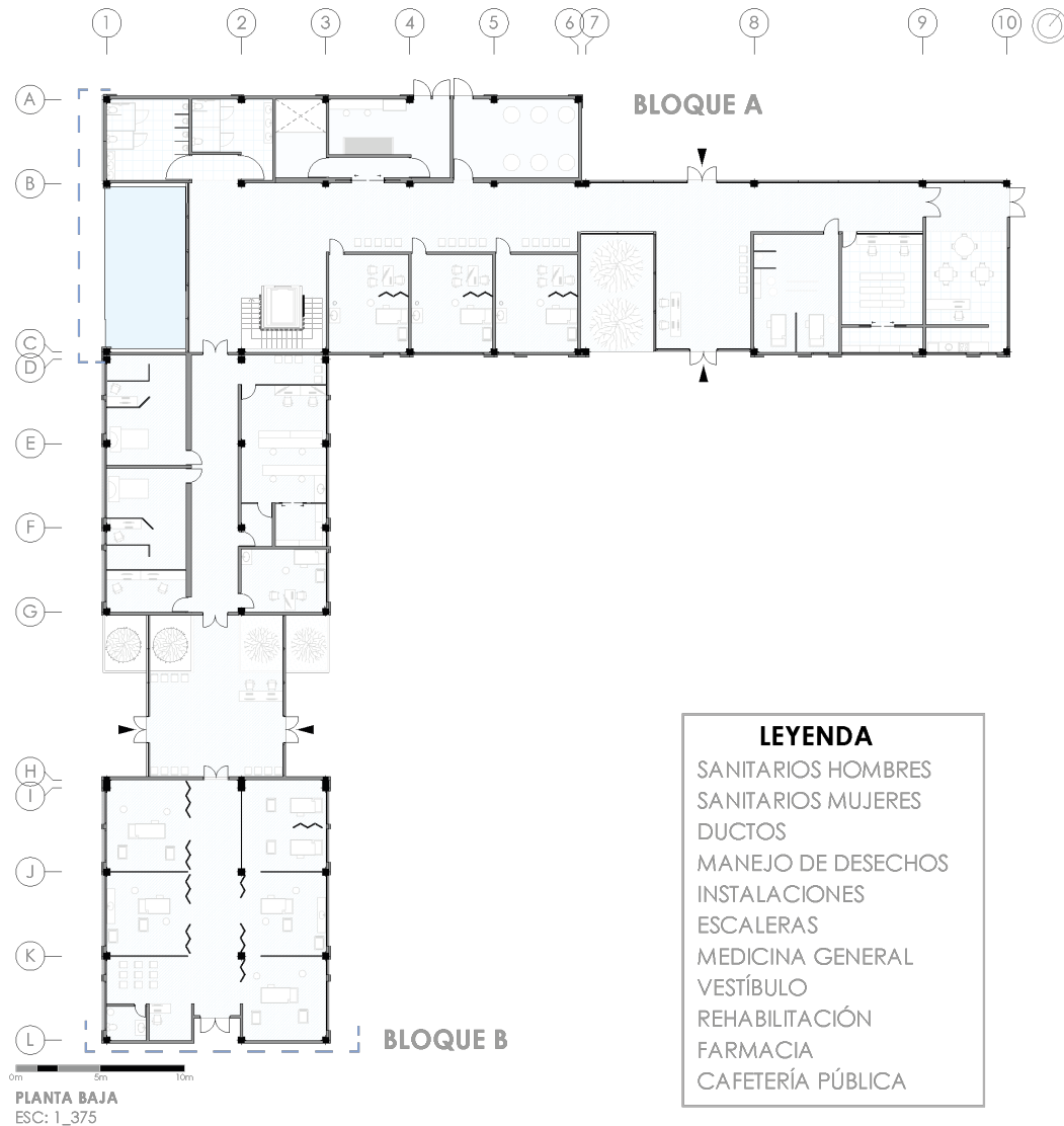
FIGURA 3.12: Planta baja Elaboración: elaboración propia
