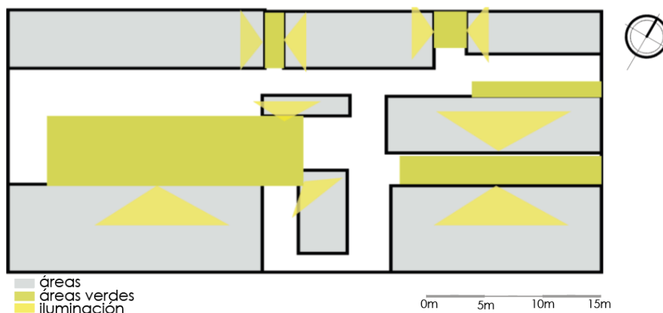
FIGURA 1.32: Centro de salud Oleiros: iluminación Fuente: (Abalo Alonso Arquitectos 2009) Elaboración: Narváez y Palacios
