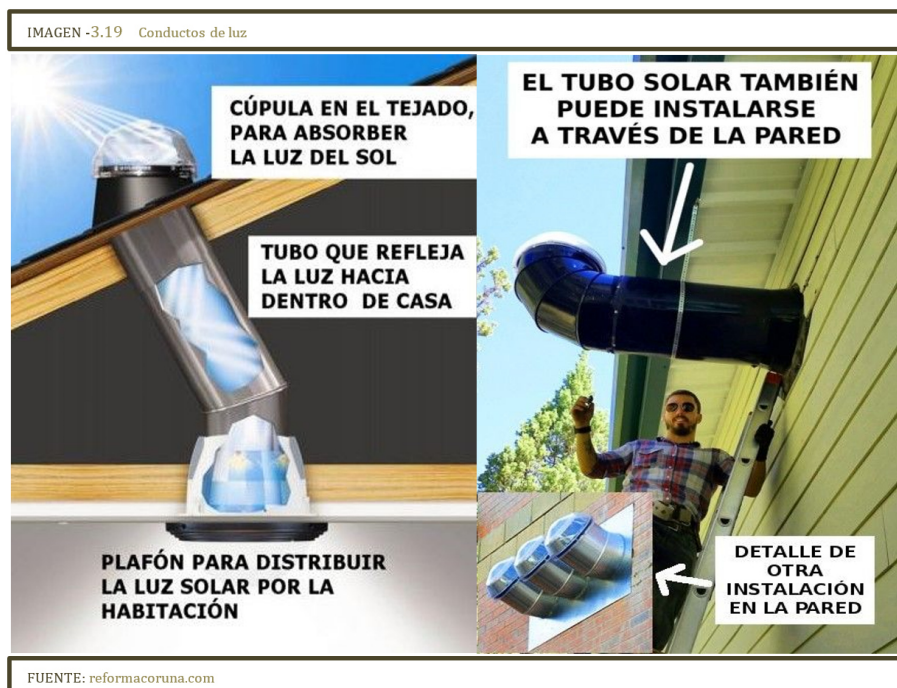
FIGURA 3.18: Tubos conductores de luz natural
