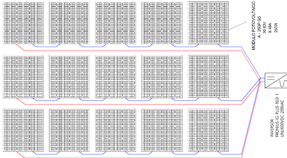
Figura 71. Diagrama módulos solares A-260P GS, cinco conectados en serie y tres conectados en paralelo.
