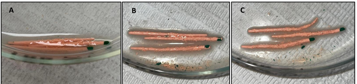
Figura 2. Conos de gutapercha sumergidos en aceite esencial de árbol de té en concentración del 100%, A) se observan cambios en la composición estructural de los conos de gutapercha a los 2 minutos de exposición, B) se puede observar desprendimiento del material a los 4 minutos, C) a los 6 minutos de exposición se pudo observar que el material perdió su integridad y resistencia volviéndose totalmente manipulable.
