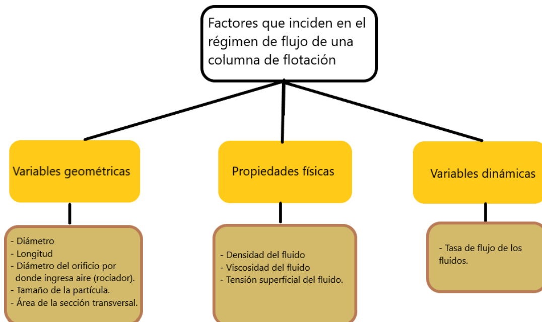
Figura 6. Factores que inciden en el régimen de flujo de una columna de flotación.
