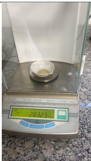
Peso final de la bentonita
