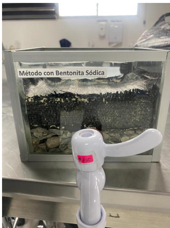
Figura 9: Método de impermeabilización con Bentonita Sódica
