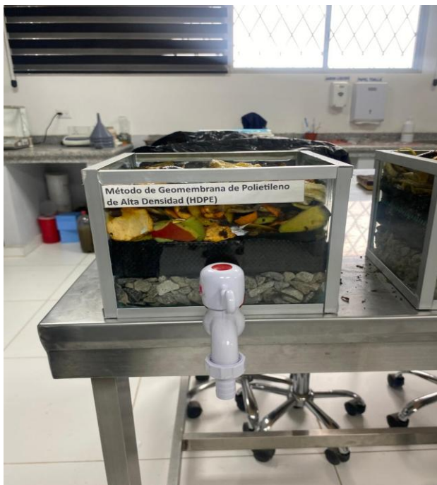
Figura 2: Configuración con recubrimiento solo en la base
