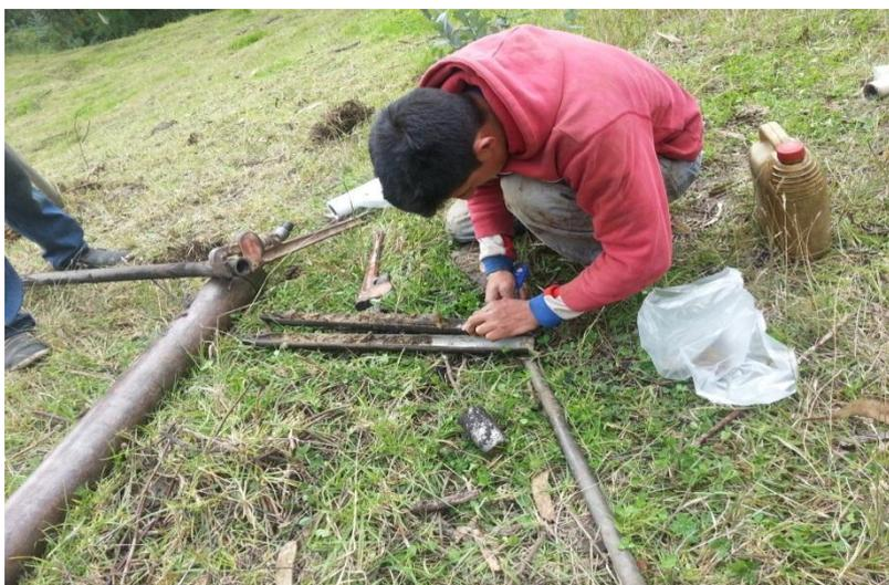
Foto 21: Perforación para toma de muestras en la vía a paredones
