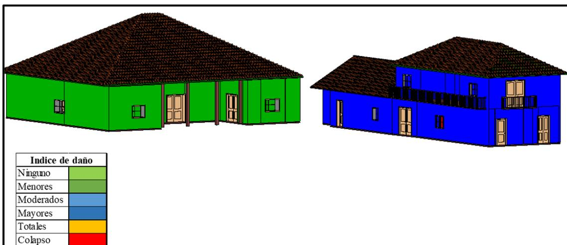
**Figura 36.** Representación del índice de daño de la Casa-Hacienda para la menor aceleración en roca establecida por la NEC
