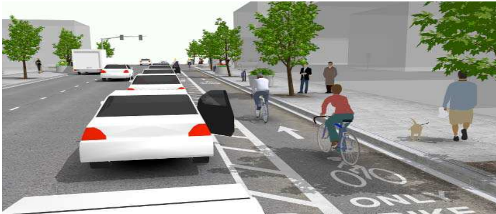
Ejemplo señalización de carril bicicleta con espacio de seguridad para apertura de puertas en estacionamientos (se recomienda que el ancho mínimo entre carril bicicleta y parqueadero sea de 500 mm y un ancho óptimo de 800 mm) Fuente: NACTO
