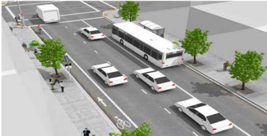
Ejemplo señalización carril bicicleta ubicado al lado izquierdo del carril para vehículos motorizados Fuente: NACTO
