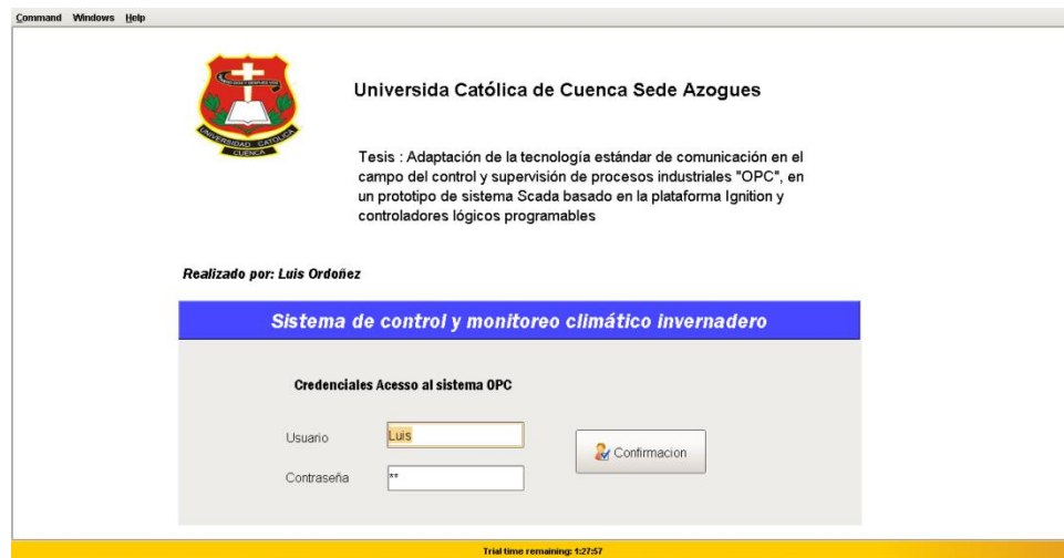
Figura 3.59 Ejecución de la aplicación SCADA como cliente OPC UA Autor ().
