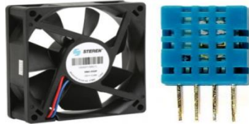
Figura 3.72 Motor de ventilador de 12 voltios DC y sensor de temperatura DHT11 de 5 voltios DC Autor ().
