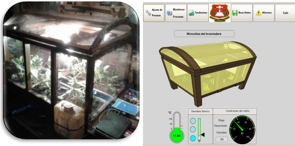
Figura 4.7 Vista del invernadero con las pruebas de control automático del SCADA Autor ().
