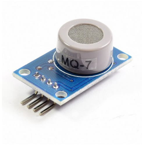
Figura 2.3: Sensor de Monóxido de Carbono MQ7 Fuente: (NAYLAMP, 2018)
