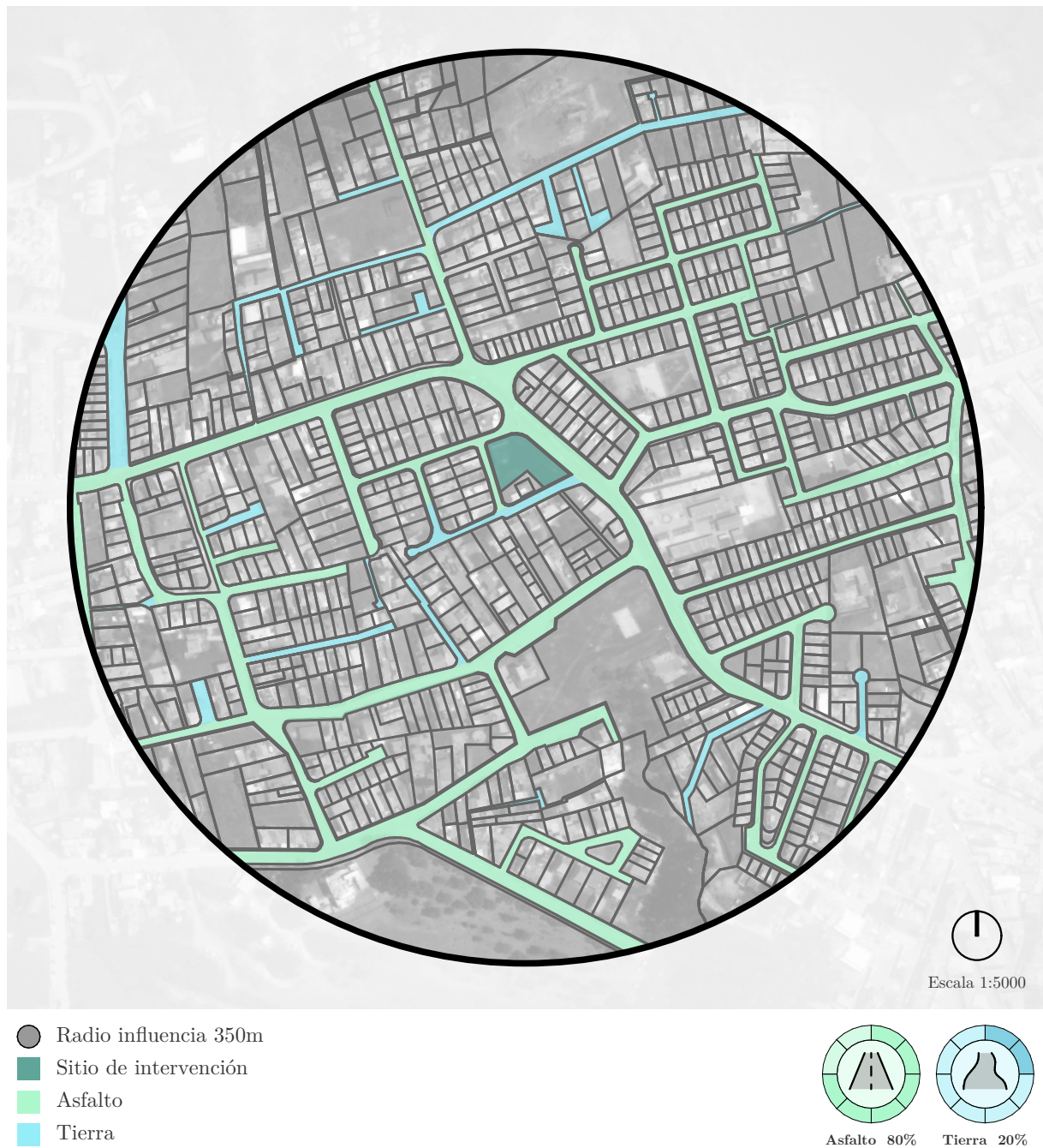
FIGURA 3.14: Capa de rodadura. Elaborado: Autores.
