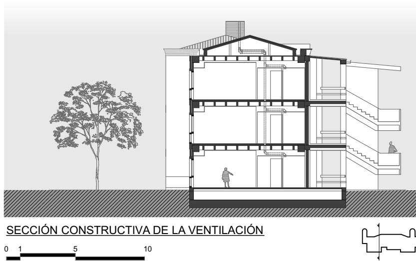
FIGURA 3.19: Sección constructiva del sistema de ventilación
