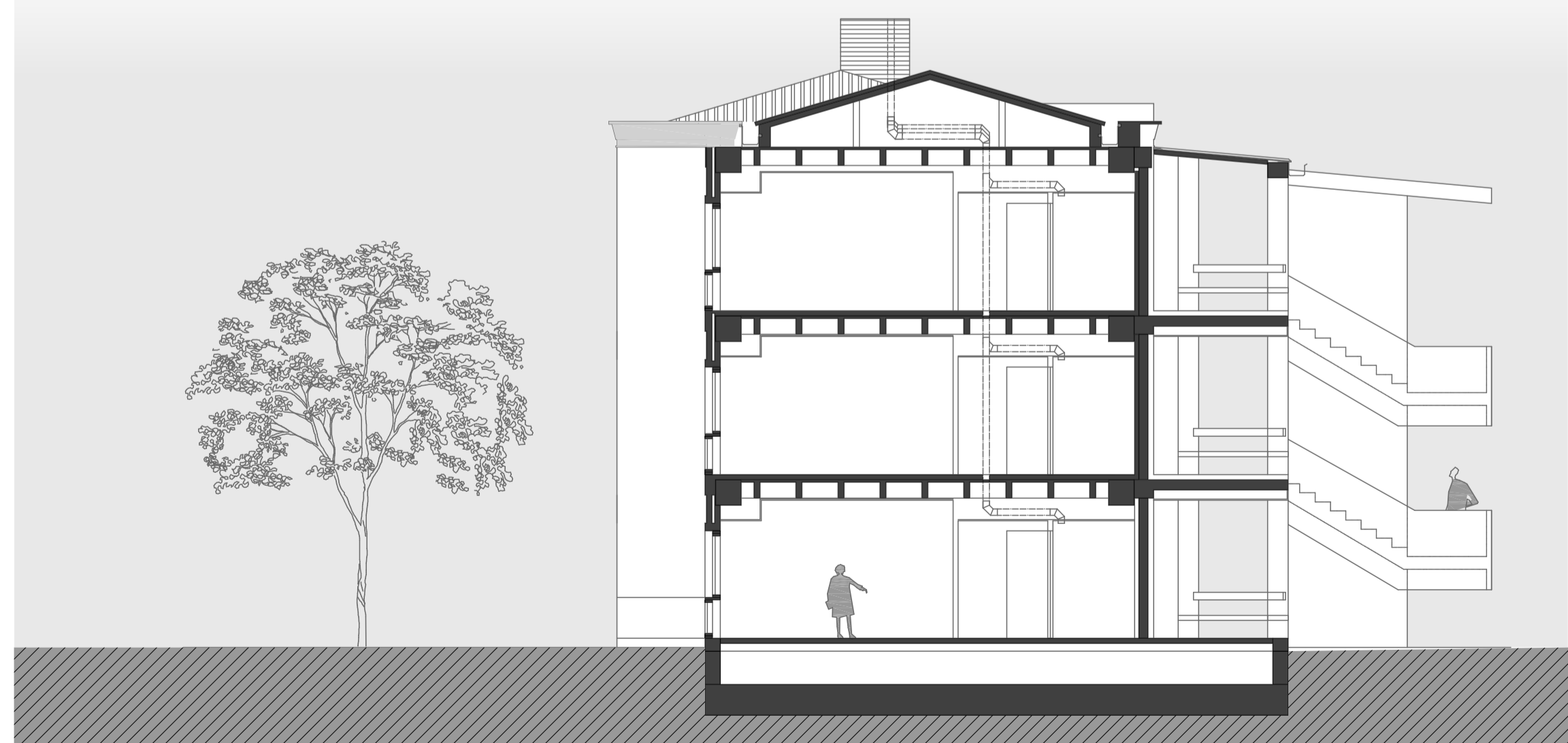
SECCIÓN CONSTRUCTIVA DE LA VENTILACIÓN
