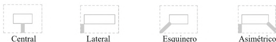
FIGURA 5.10: Tipos de ingresos a edificaciones
