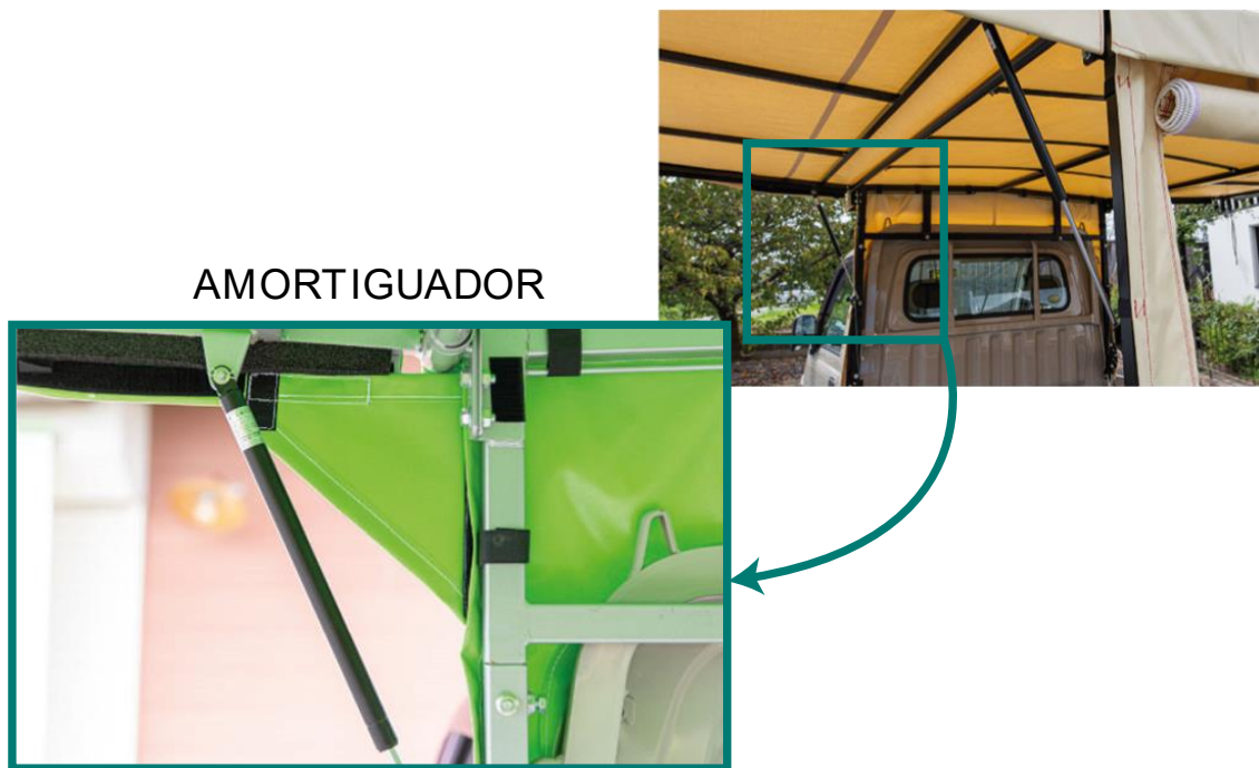
Figura 51: Amortiguador en estructura
