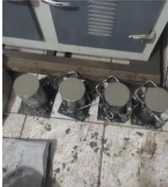
4.- Probetas de hormigón
