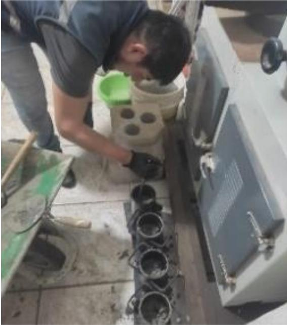
3.- Hormigonado de probetas
