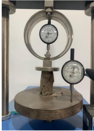
Ilustración 47: Ensayo de compresión simple Fuente: Los autores
