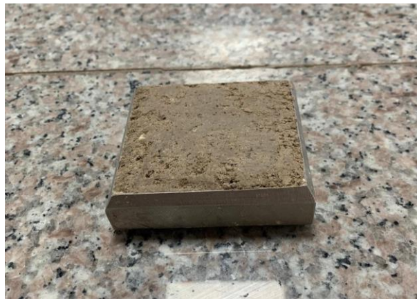
Ilustración 54: Anillo de corte con muestra inalterada Fuente: Los Autores
