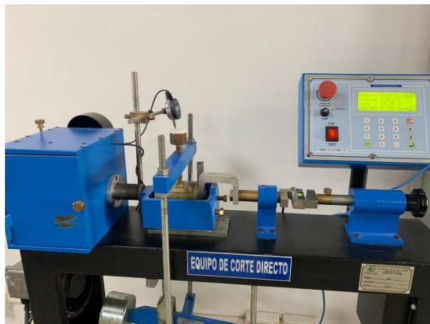
Ilustración 55: Equipo para realizar el ensayo de corte directo Fuente: Los Autores
