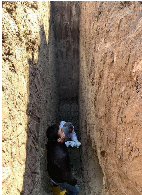
Ilustración 22: Vista de la estratigrafía de la calicata 1 Fuente: Los Autores
