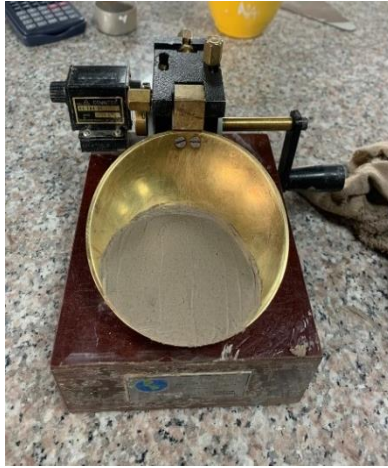
Ilustración 36: Ensayo límite líquido Fuente: Los Autores
