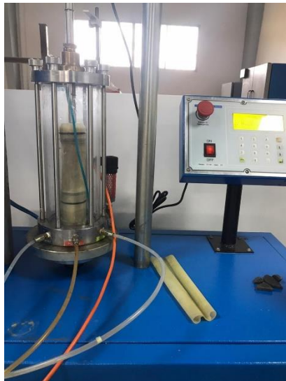
Ilustración 57: Cámara a presión para ensayo triaxial Fuente: Los Autores
