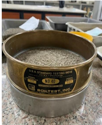
Ilustración 35: Muestra pasando por el tamiz #40 Fuente: Los Autores
