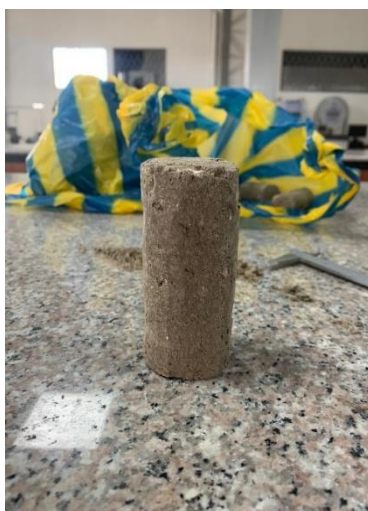
Ilustración 46: Cilindro para compresión simple
