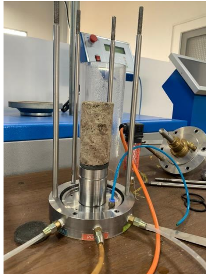
Ilustración 56: Muestra inalterada cilíndrica para ensayo triaxial Fuente: Los Autores
