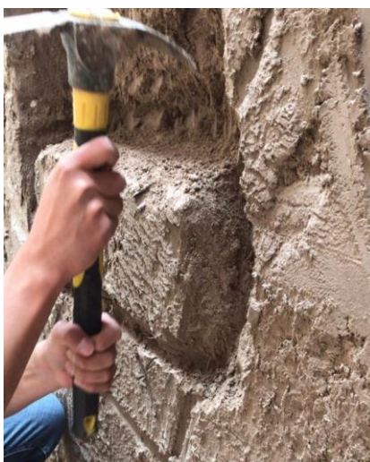
Ilustración 26: : Extracción de muestra inalterada calicata 3
