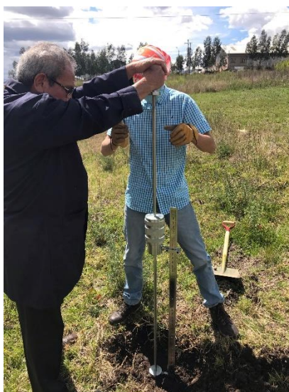
Ilustración 60: Equipo para realizar el ensayo DCP
