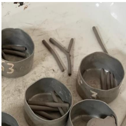
Ilustración 44: Rollos para obtener el límite plástico Fuente: Los Autores
