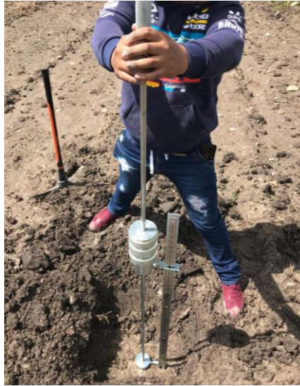
Ilustración 61: Ensayo DCP de un suelo húmedo Fuente: Los Autores
