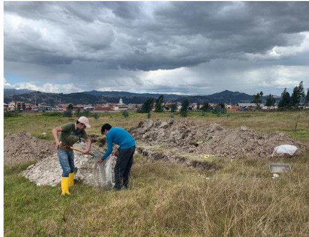
Ilustración 24: Muestras alteradas de la calicata 2 Fuente: Los Autores
