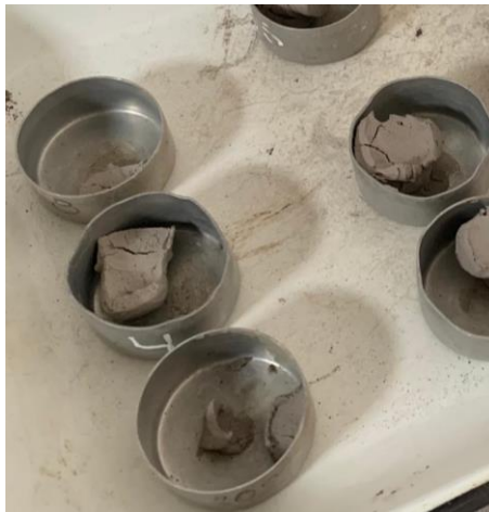
Ilustración 37: Proceso de obtención del límite líquido Fuente: Los Autores
