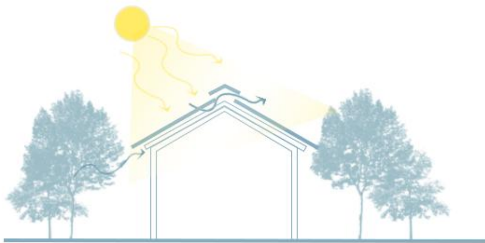
Figura 22: Diagrama descripción del funcionamiento de las cubiertas Ventiladas
