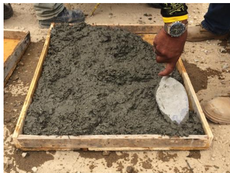
Figura 32: Esparcimiento de la mezcla en el molde referente 1
