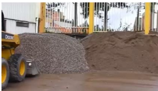
Figura 54: Árido fino (arena de río)
