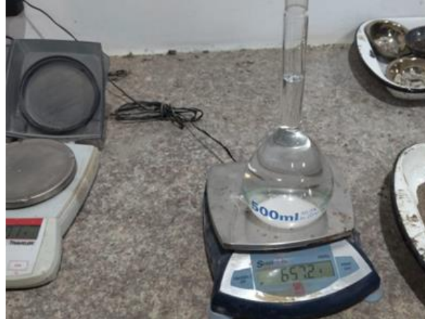
Figura 64: Pesado del picnómetro con agua
