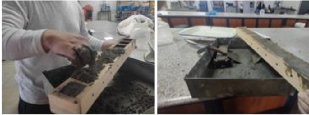
Figura 69: Rellenado de moldes
