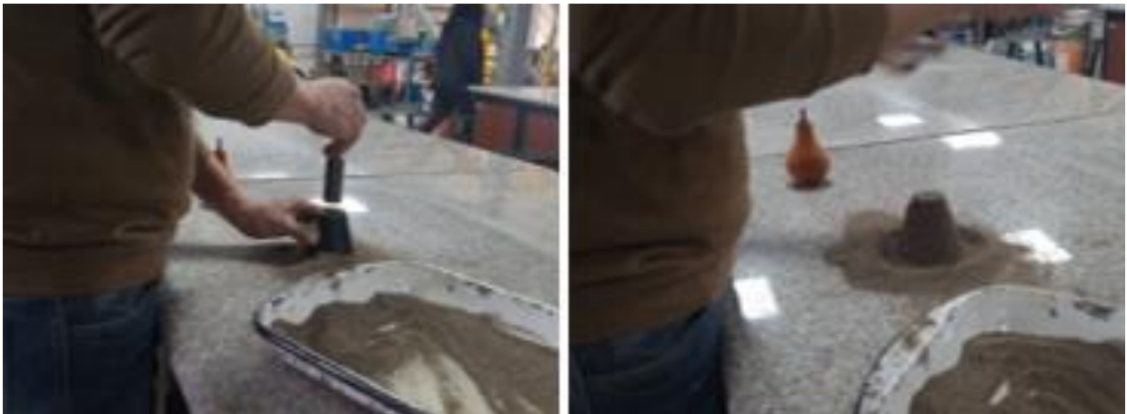
Figura 63: Consistencia del árido fino
