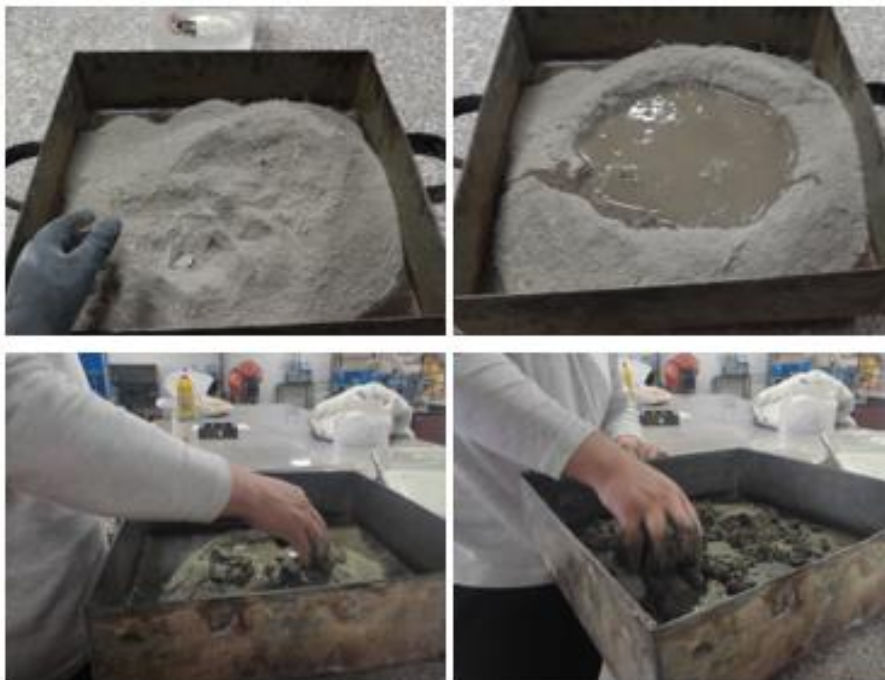
Figura 68: Mezclado de materiales para probetas
