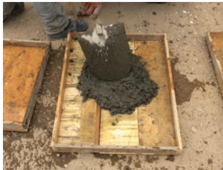
Figura 31: Vertido de la mezcla aligerada sobre el molde referente 1
