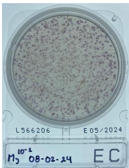
Gráfico 2. Mediante placas Compact Dry EC se observa la presencia de coliformes en la dilución 1/100.
