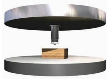
Ilustración 10 Esquema de ensayo de dureza de una pieza de madera Fuente: (CORMA, 2010)
