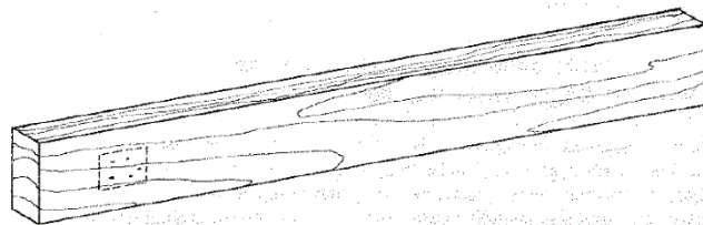
Ilustración 32 Perforaciones pequeñas Fuente: (JUNAC, 1984)
