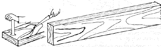
Ilustración 25 Escamadura o acebollado Fuente: (JUNAC, 1984)
