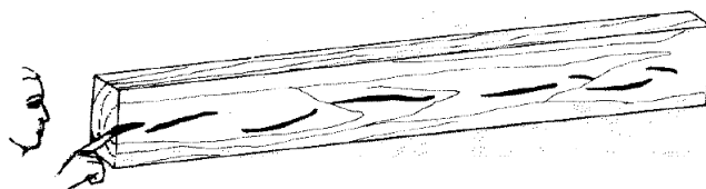
Ilustración 24 Duramen quebradizo Fuente: (JUNAC, 1984)
