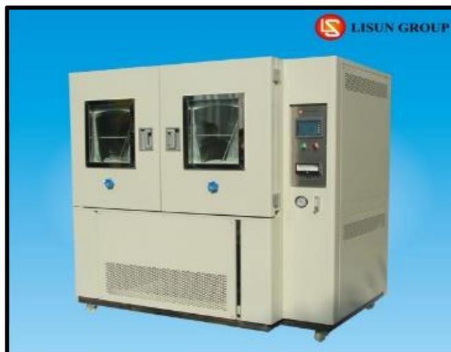
Fig. 1. Equipo SC-015 de pruebas de hermeticidad del polvo.
