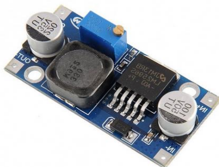
Fig.18 Estabilizador regulador DC-DC Fuente. (“Estabilizador / regulador DC-DC LM2596 1.23-37V 2ª,” 2006.)
