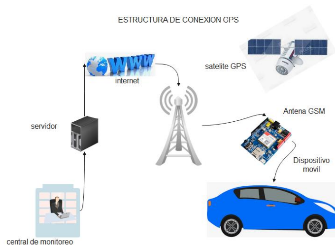
Fig.19 Estructura de comunicación GPRS. Fuente. El Autor.
